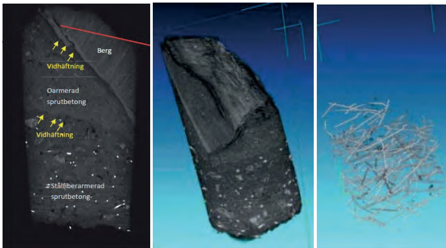
Figur 29. Borrkärna med fiberarmerad och oarmerad sprutbetong på bergkil. Från Ansell m.fl. (2016).
