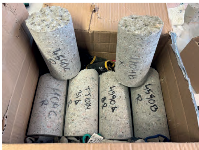
Figur 26. Provcylindrar från järnvägstunnel. Två har undersökts. Figure 26. Test cylinders from railroad tunnel. Two were investigated.
