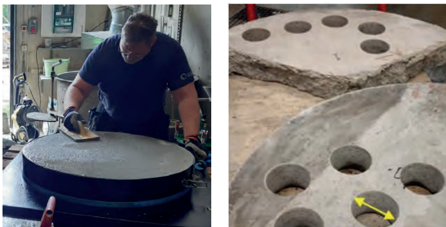
Figur 24. Gjutning av RDP platta och dess delar efter provning. Foton från Vattenfall och Rengarajan (2020).
