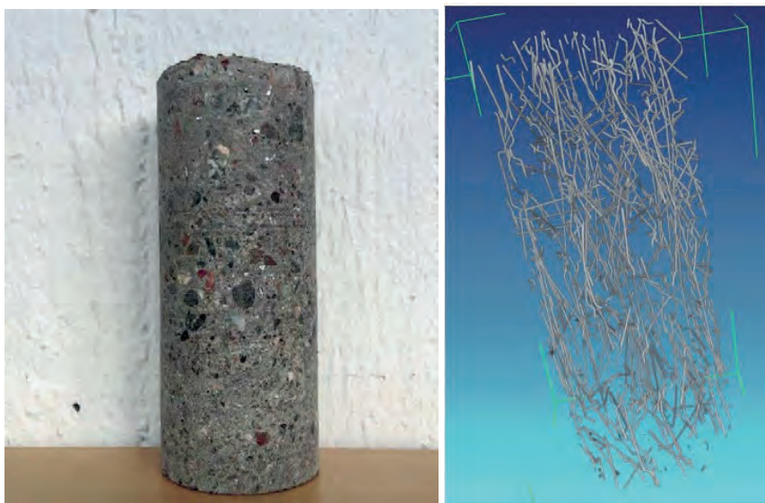
Figur 30. Borrkärna ur fiberarmerad sprutbetongbalk och dess fibrer. Överändan har varit nedsänkt i vatten. Från Ansell m.fl. (2016) och Ansell (2021).
