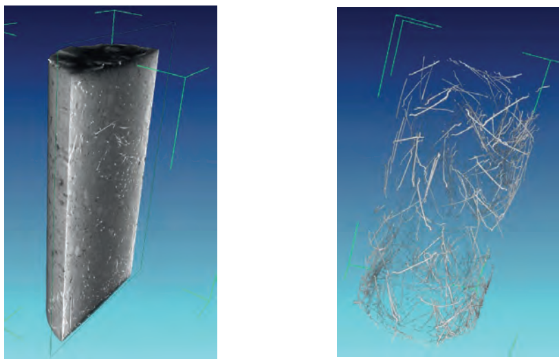
Figur 2. Tredimensionell visning av betongcylinder vertikalt mittsnitt (vä.) och dess stålfibrer (hö.) (Ansell m.fl., 2016) Figure 2. Three dimensional view of concrete cylinder vertical section (L) and its steel fibres (R) (Ansell et.al., 2016).
