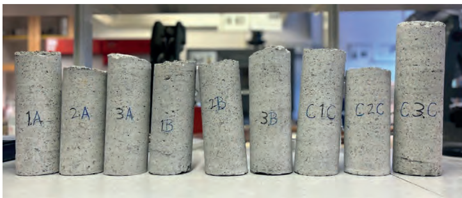
Figur 25. Provcylindrar från LKAB. Tre uppsättningar om tre vardera. Figure 25. Test cylinders from LKAB. Three sets of three cores each.
