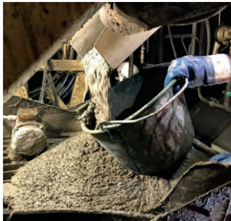
Figur 7. Provtagning av stålfibersprutbetong. Från (Oustampasidis, 2019).
