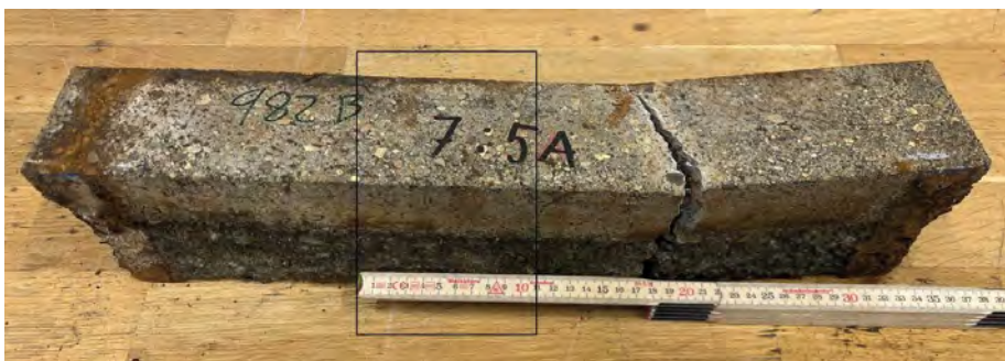
Figur 4. Område för provuttag till struktur- och kemanalys. Figure 4. Area for sample to structure and chemical analysis.
