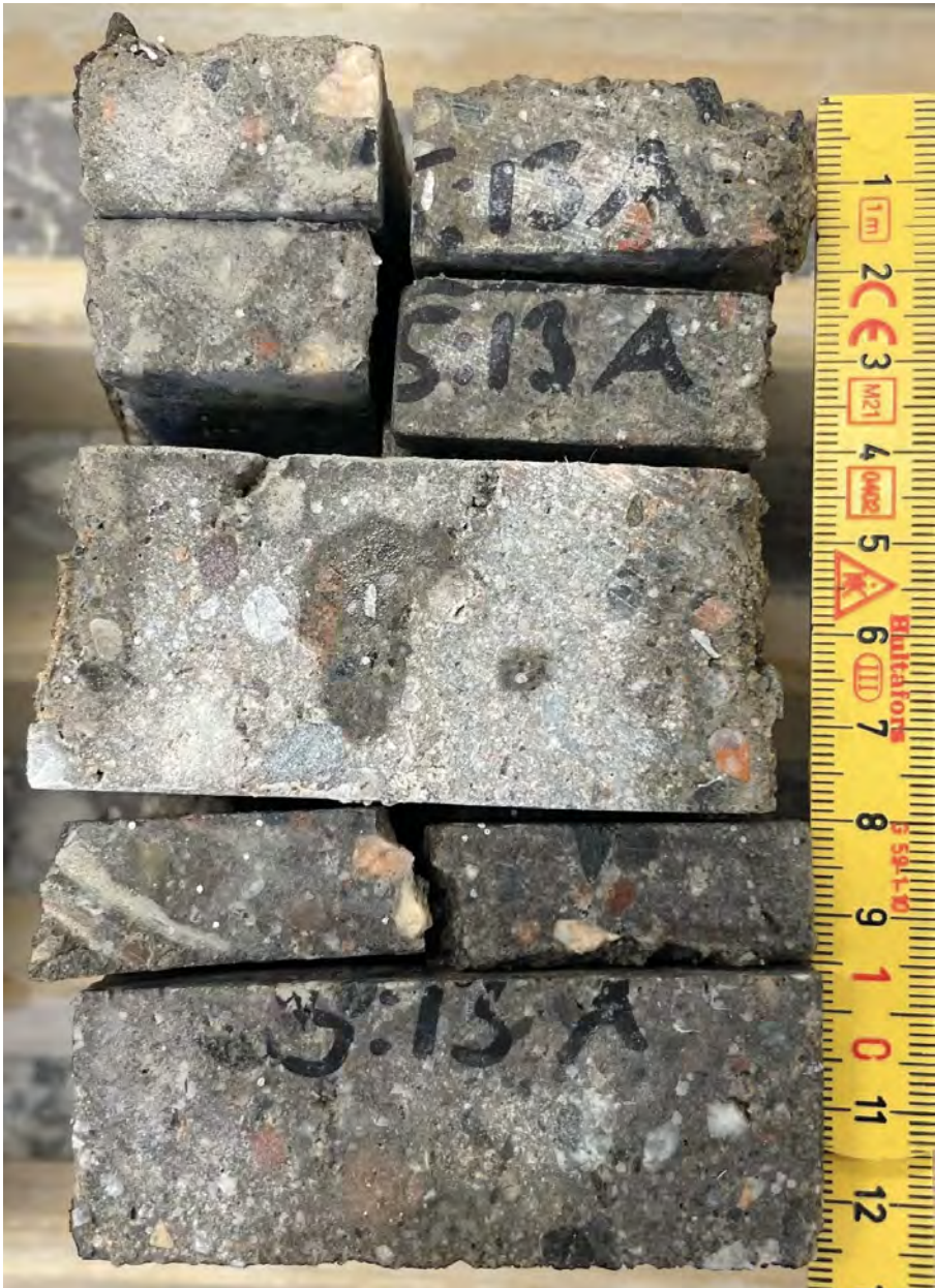
Bild 3. Prov "5:13A" efter sågning av bitar som användes för tillverkning av tunnslip och för analys i SEM.
