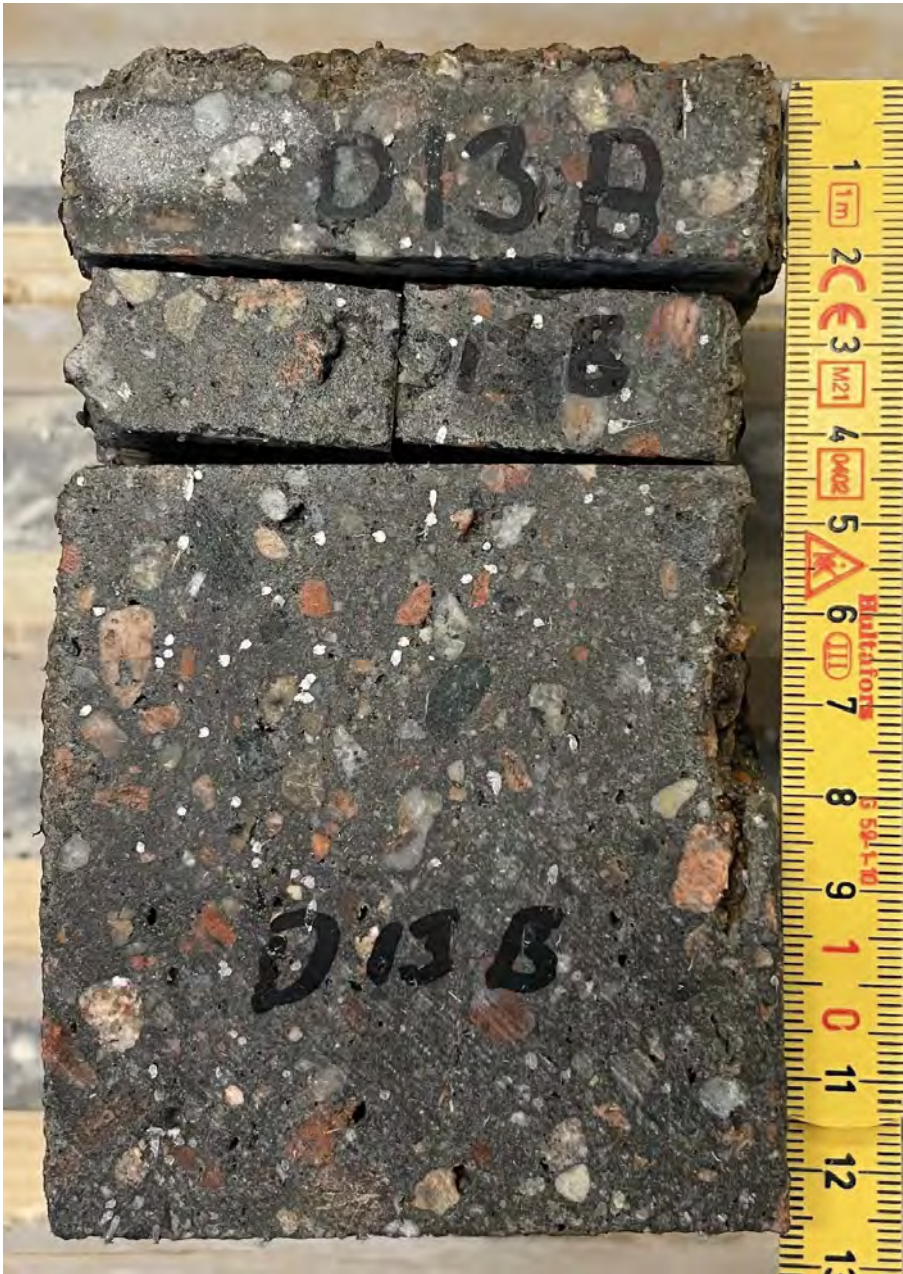
Bild 7. Prov "D:13B" efter sågning av bitar som användes för tillverkning av tunnslip och för analys i SEM.
