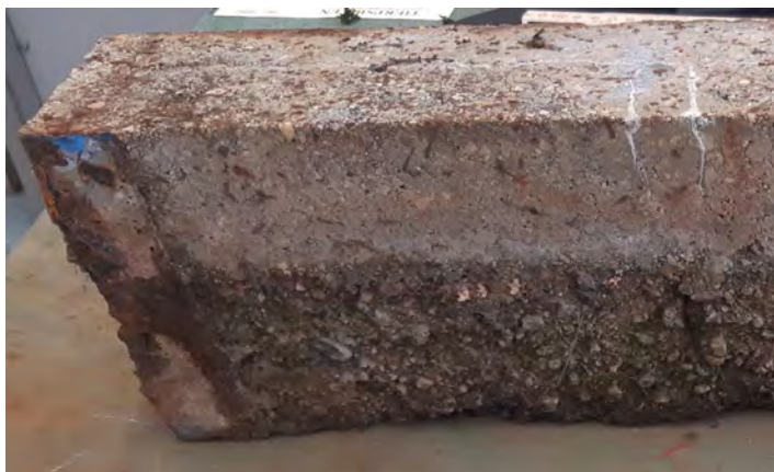
Figur 6. Eroderad och opåverkad yta (under fästplatta). Figure 6. Eroded and unaffected surface (under mounting plate)
