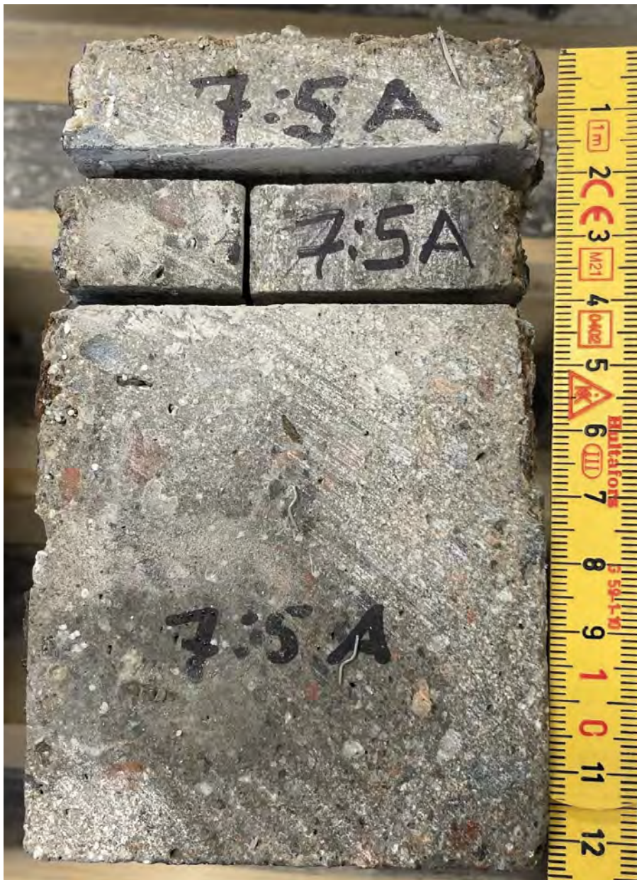
Bild 5. Prov "7:5A" efter sågning av bitar som användes för tillverkning av tunnslip och för analys i SEM.
