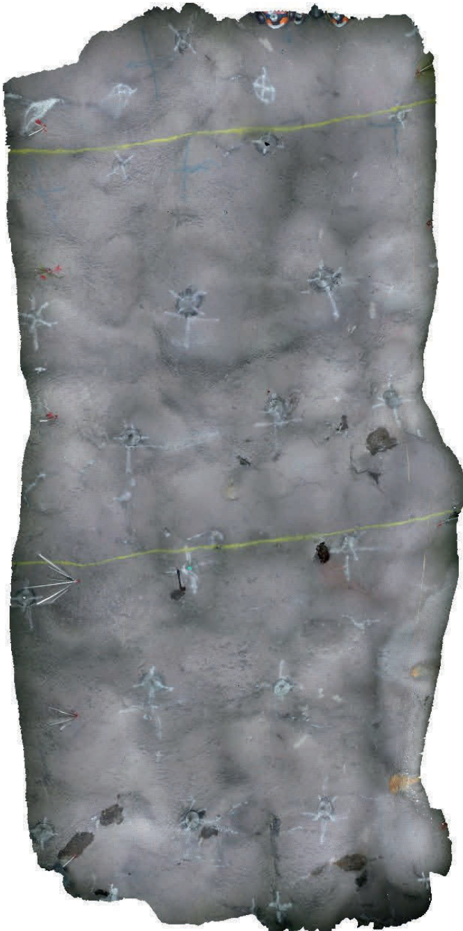
Figur 56: Modell efter slitsar ristats in, skapad med film från GoPro kamera
