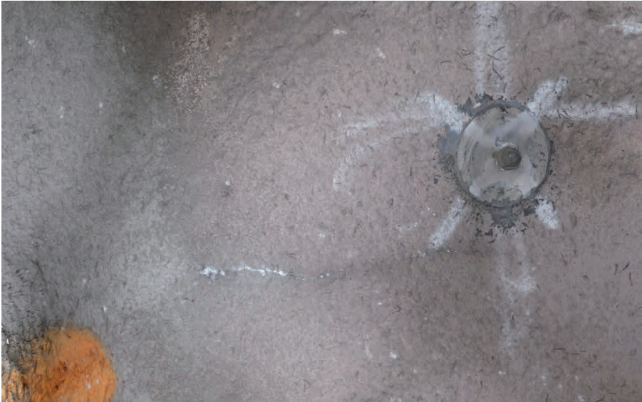
Figur 63: Naturlig spricka från 3D-modell baserat på fotografier med Systemkamera Fujifilm X-E2
