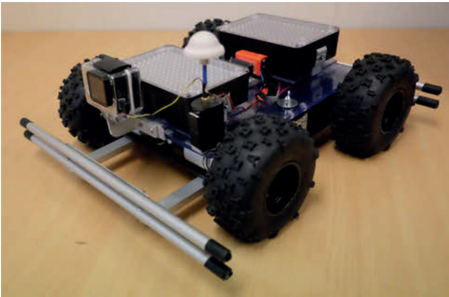
Figur 49 Apparatbäraren med belysning och uppåtriktad kamera vid körning Torsgatan
