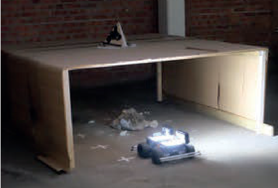
Figur 69 Försöksuppställning vid fotografering av nedfall
