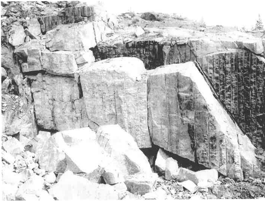
Figur 13. Stenblock efter sprängning av tätsöm
