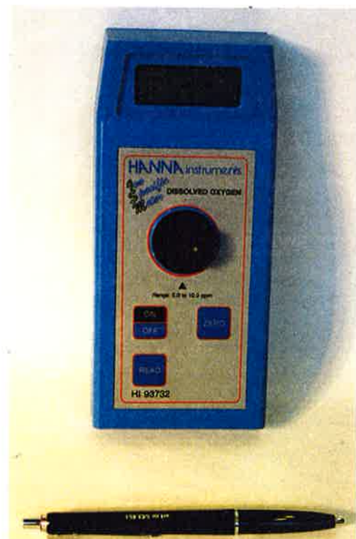
Figur 4.24 Syremätare HI93732 för att mäta syrehalt i vatten.
