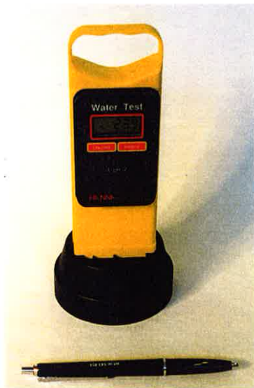
Figur 4.23 Water Test för att mäta vattens pH värde, konduktivitet (dvs resistivitet) och Redox potential.
