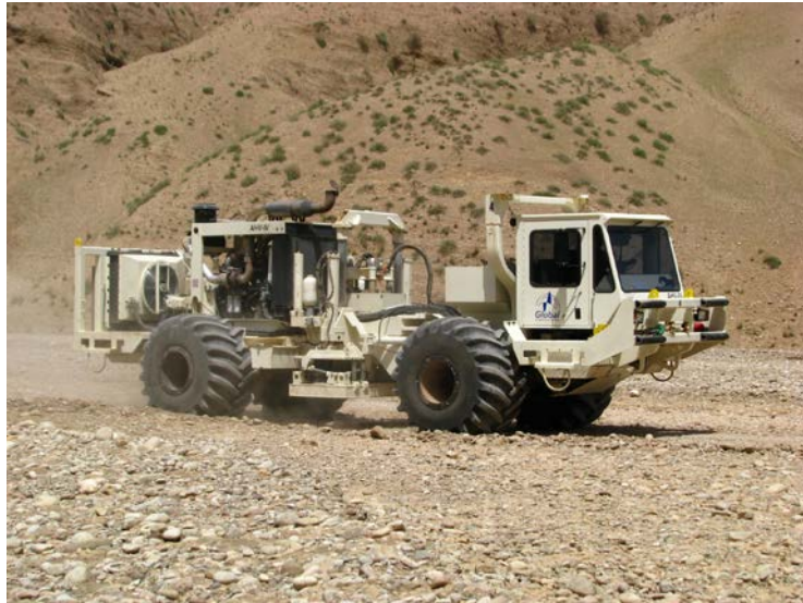
Figur 3.2. Vibroseistruck 3 – 150 Hz. Chassiet lyfts upp med domkrafter och hela ekipaget vilar på plattan mellan hjulpåren. Plattan överför vibrationerna till marken. The chassi is lifted and the vehicle rests on the circular plate between the wheels.
