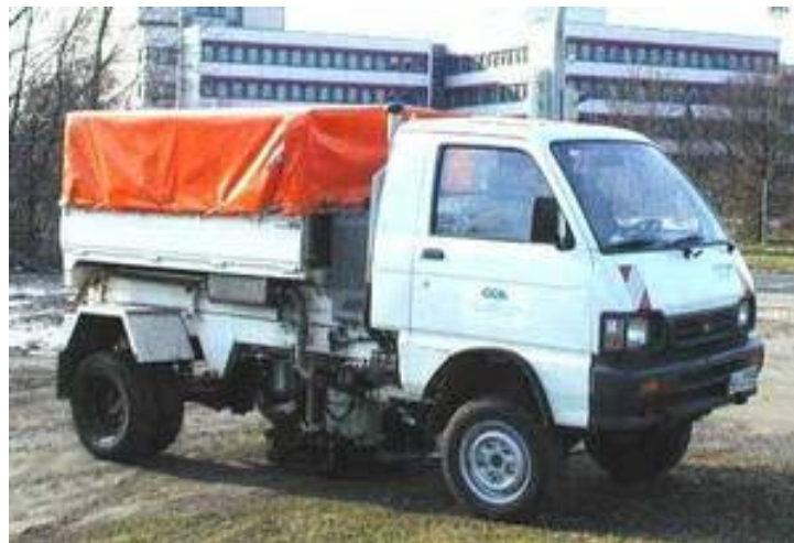
Figur 3.1. MHV 2.7 Hydromekanisk vibrator för 16-500 Hz Hydromechanical vibrator
