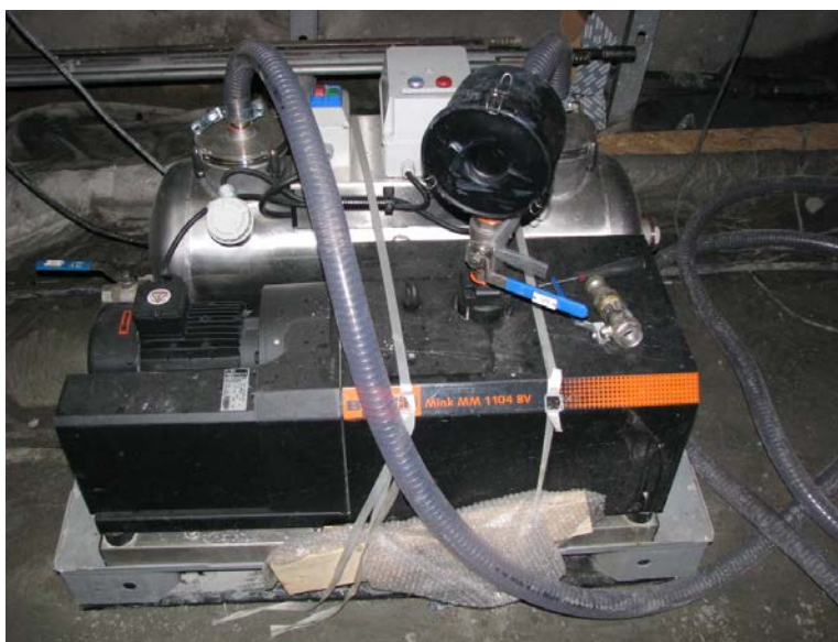
Figur 3-4. Vakuumpump från ett tätningsprojekt i Telias tunnlar.
