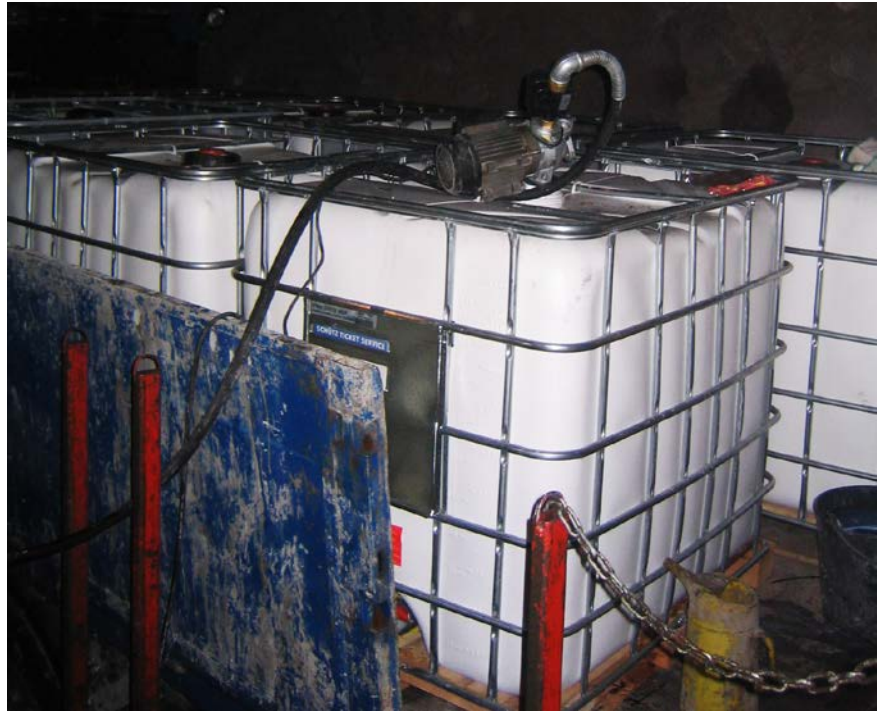
Figur 3-2. 1m 3 behållare med silica sol och saltlösning från ett projekt i en av Telias tunnlar.
