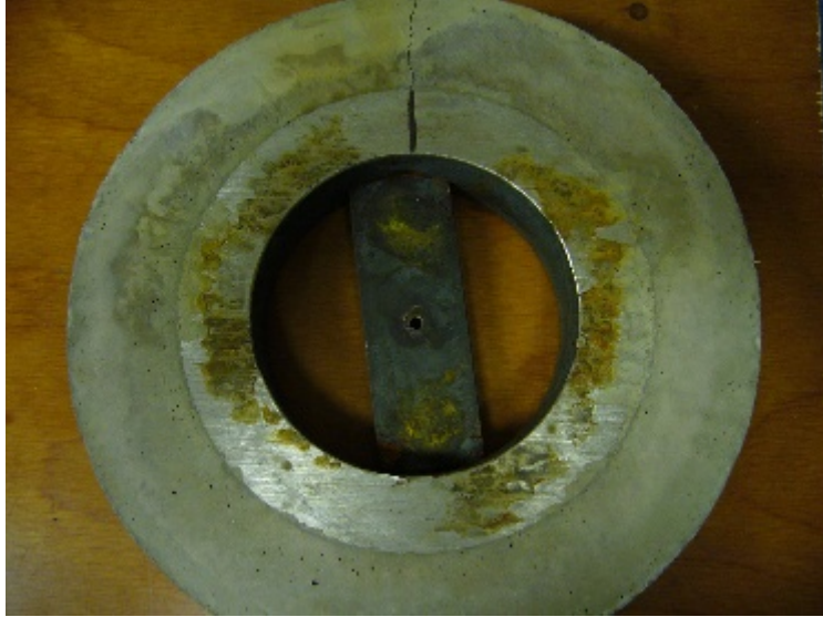
Figur 5.2 Provkropp av betong 1, oarmerad referensbetong, 100 dygn efter gjutning. Test specimen of concrete 1, un-reinforced reference, 100 days after casting.
