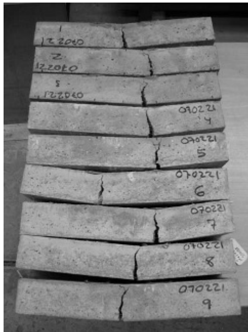
Figur 4.6 Uppsprickning efter provning av betong 4, stål- och glasfiberarmerad betong. Bending cracks after testing concrete 4, steel and glass fiber reinforced.
