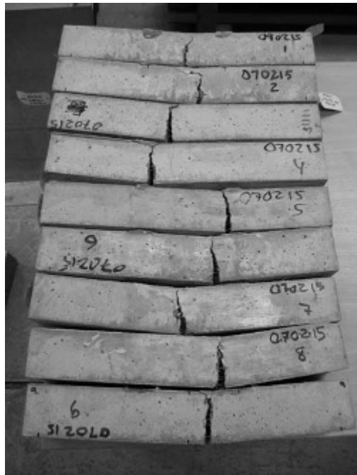
Figur 4.2 Uppsprickning efter provning av betong 2, stålfiberarmerad referensbetong. Bending cracks after testing concrete 2, steel fiber reinforced reference.
