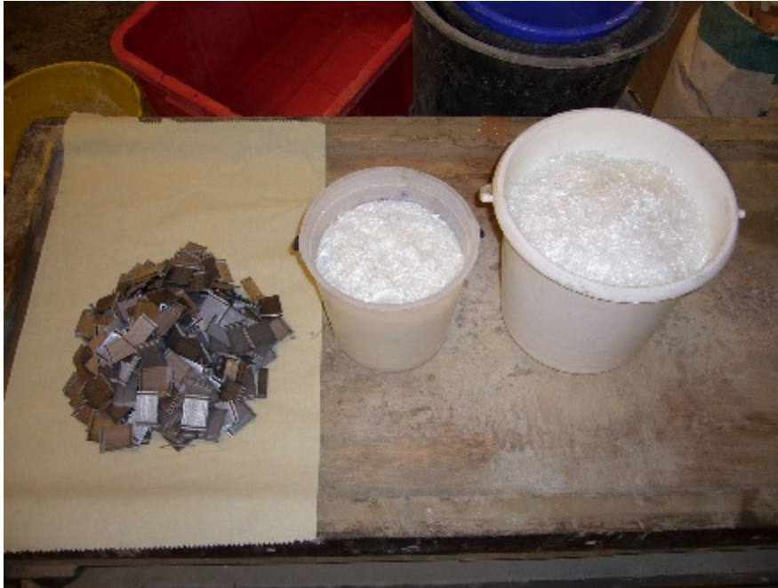
Figur 2.2 Stålfibrer Dramix 30/05 , 6 mm och 12 mm långa glasfibrer. Volymförhållanden enligt betongrecepten.
