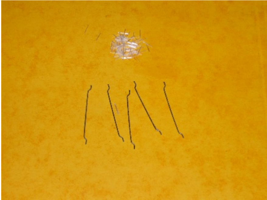
Figur 2.1 Stålfibrer av typ Dramix 30/05 och 6 mm långa glasfibrer. Steel fibers Dramix 30/05 and 6 mm glass fibers.
