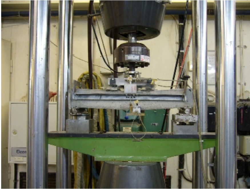
Figur 2.5 Böjbalk monterad på rigg i MTS provningsmaskin. Beam mounted in test rig in MTS testing machine.
