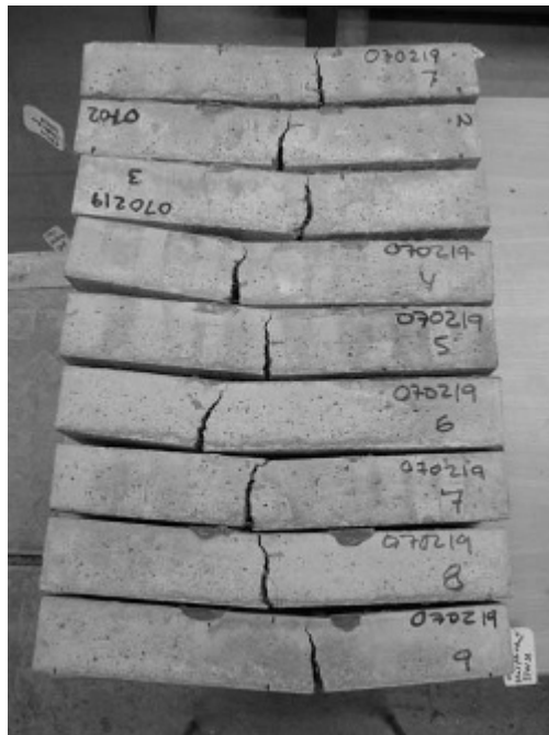
Figur 4.4 Uppsprickning efter provning av betong 3, stål- och glasfiberarmerad betong. Bending cracks after testing concrete 3, steel and glass fiber reinforced.
