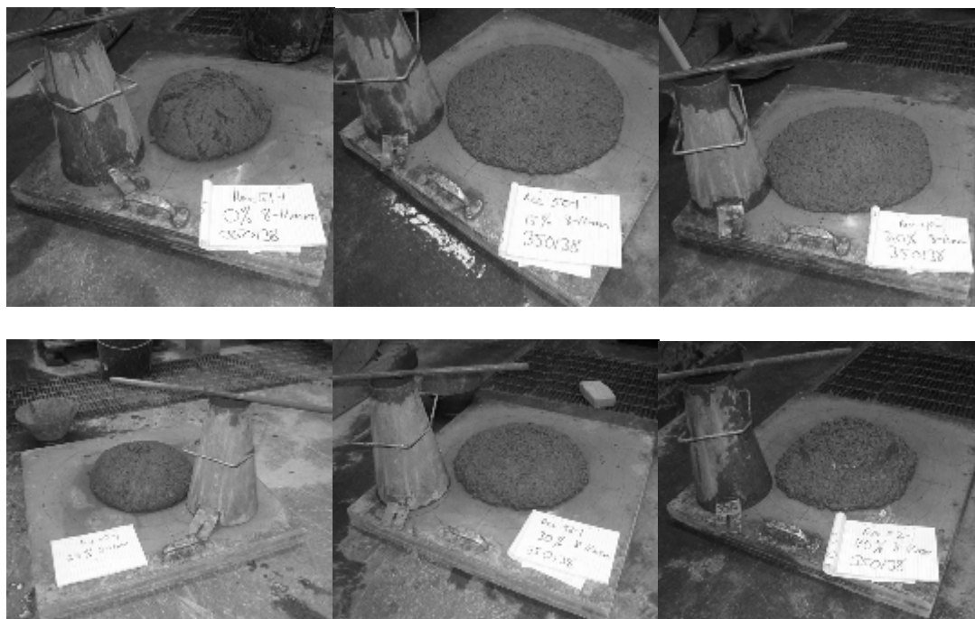
Figur 4.22. Betonger med 380 kg cement, vct 0,50 och olika andelar 8/11 mm sten. Övre raden från vänster till höger: 0 %, 15 % samt 20 % 8/11 mm sten. Undre raden från vänster till höger: 25 %, 30 % samt 40 % 8/11 mm sten.
