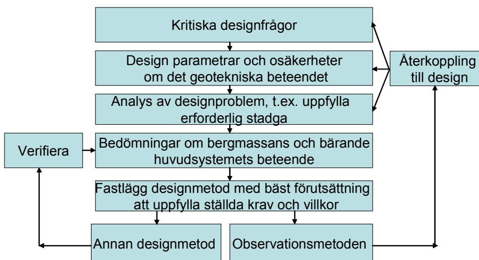
Figur 2-3. Principiell jämförelse mellan att använda observationsmetoden och annan designmetod. Anpassning av design är formellt möjlig med observationsmetoden. Inriktning på kontroller som görs för andra designmetoder har fokus på verifikation av antagna designförutsättningar.
