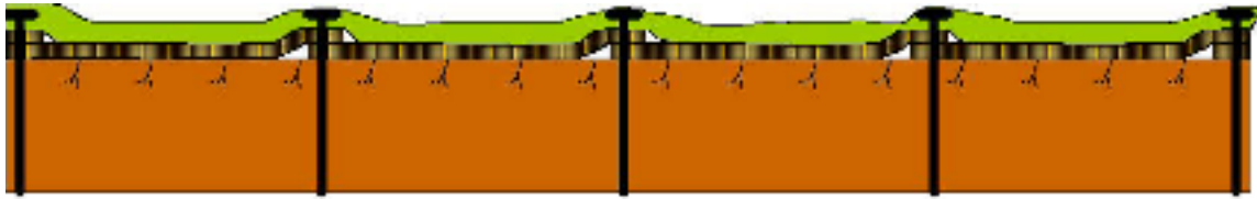
Figur 3.2 Bred, eller sammansatt drän. Konstruktionen kan utsträckas åtskilliga tiotals meter. (ELU-GOLDER HB 2005, (10)).
