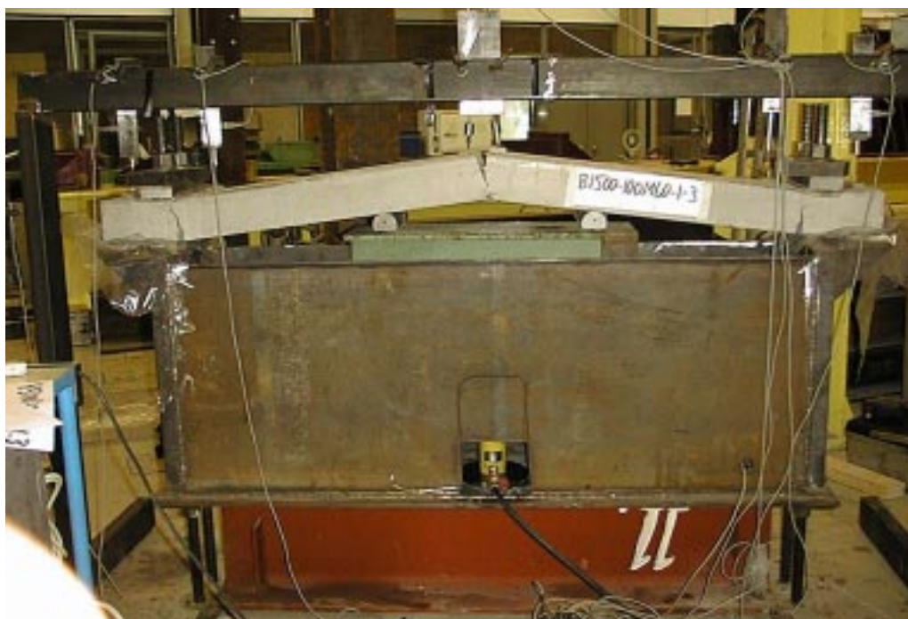
Figur 4.4 Slutligt brott i en balk Final failure of a beam
