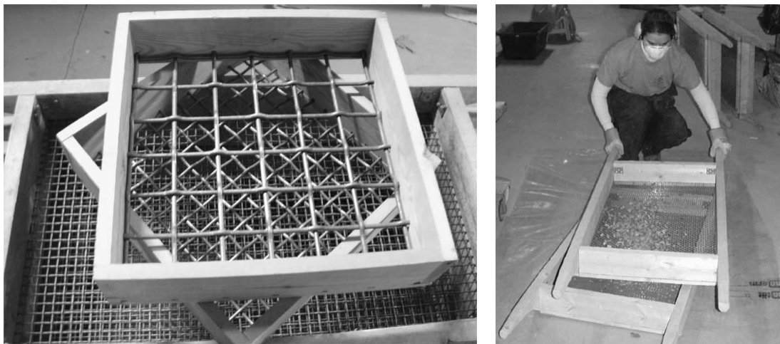
Figur 9. Eftersom det spröda bruket föll sönder under traditionell laboratoriesiktning, ersattes denna av en mer skonsam siktning.
