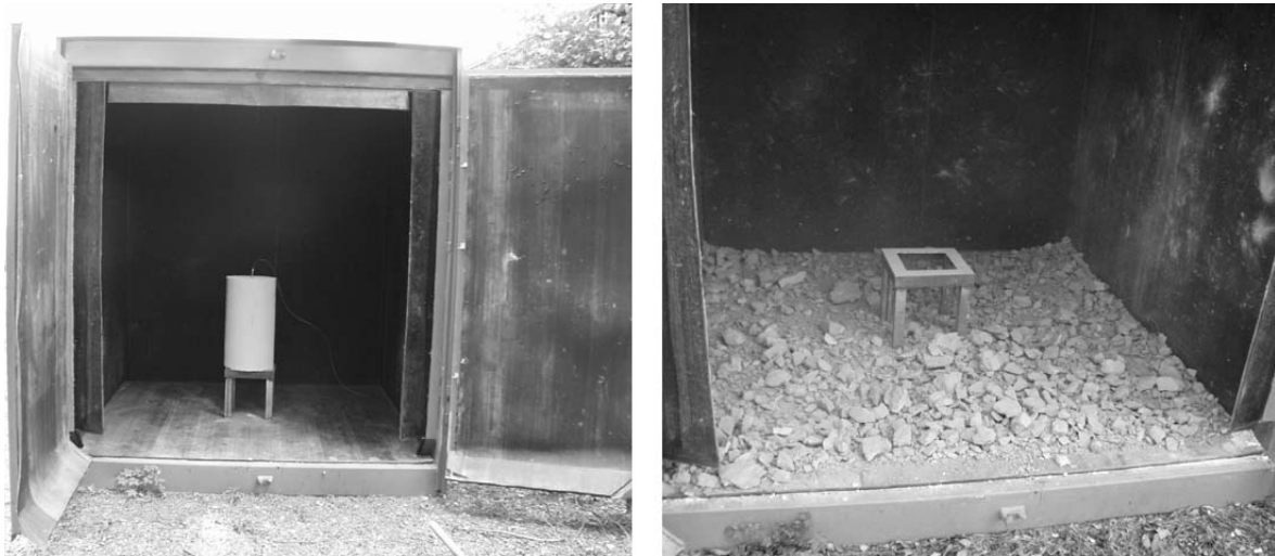
Figur 8. Sprängningarna utfördes i en specialtillverkad container.
