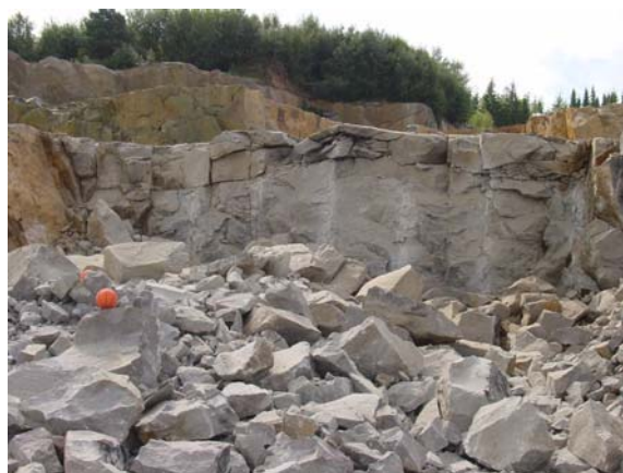
Figur 26. Styckefall från salva 4 (Ø 51 mm). Figur 27. Styckefall från salva 5 (Ø 38 mm).
