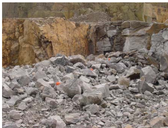
Figur 26. Styckefall från salva 4 (Ø 51 mm). Figur 27. Styckefall från salva 5 (Ø 38 mm).
