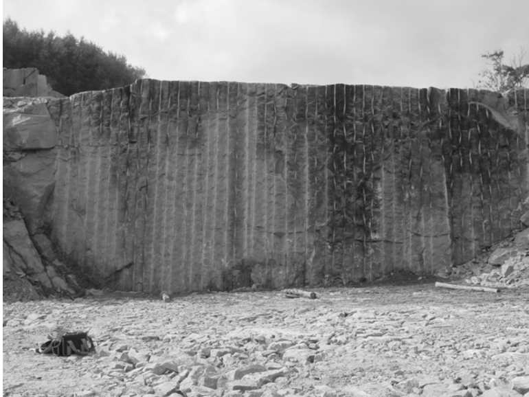
Figur 13. Rensprängd pall inför ny provomgång.
