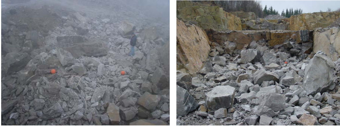
Figur 28. Styckefall från salva 6 (Ø 64 mm). Figur 29. Styckefall från salva 7 (Ø 76 mm).
