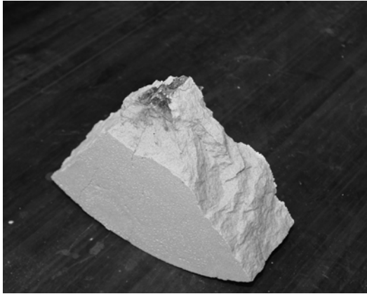
Figur 3. Sprängmedlet svärtade bruket närmast borrhålet.
