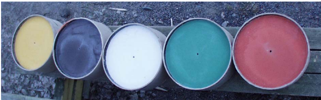
Figur 2. Mindre provkroppar användes för att undersöka huruvida pigmentet påverkades av tryck och temperatur vid sprängningen.
