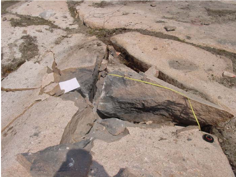
Figur 5-13 Sprängning 1 med ca 460 gram pentylsprängdeg (VOD=5986 m/s för ren PETN) i ett ca 1,0 m djupt hål och med förladdning på ca 0,7 m. Värdet SD var ca 1,1.
