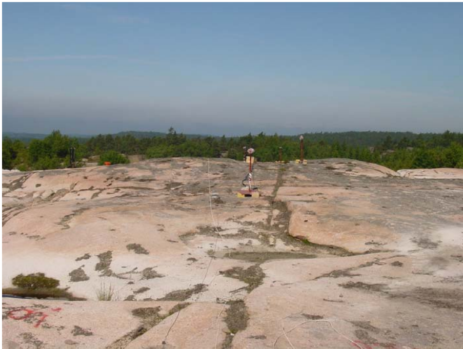
Figur 2-2 Bergets yta för försöksplats två med tre stycken tryckgivare på stöd. Laddningarna var placerade i närheten av en tänkt kameraposition för den aktuella bilden.
