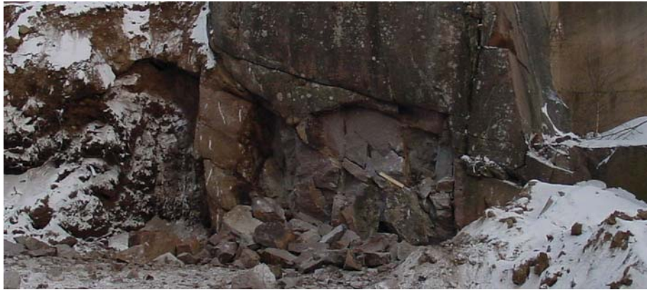
Figur 5-2 Väggen för försöksplats ett har svaghetsplan som delvis definierar de utsprängda blockens storlek. Det var därför ej möjligt att på ett meningsfullt sätt beräkna den utsprängda volymen berg utifrån en tänkt konisk utsprängd bergvolym.
