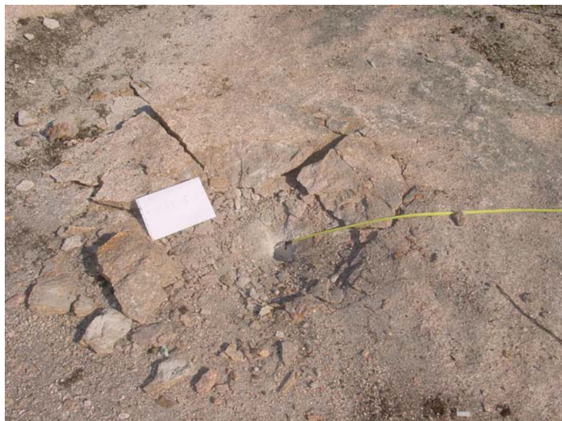
Figur 5-6 Sprängning 3 med ca 460 gram Dynamex (VOD = ca 5000 m/s) i ett ca 0,5 m djupt hål. Förladdningen av fingrus är ca 0,15 m, störda radien i ytan är ca 50 cm och SD = 0,46.
