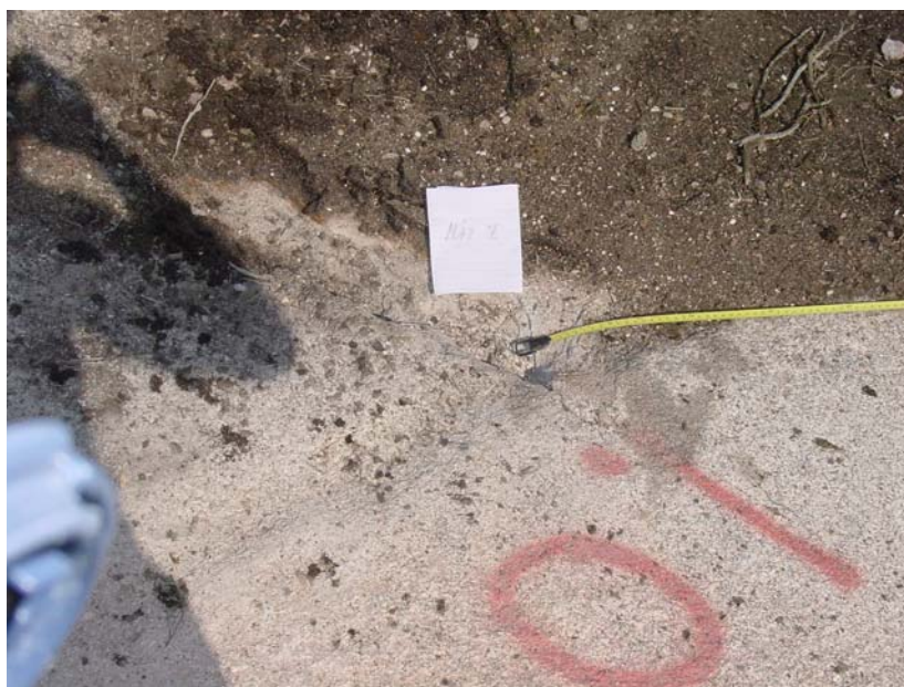
Figur 5-9 Sprängning 7 med ca 390 gram Gurit (VOD = 2000 m/s mätt på friliggande 17 mm rörladdning) och 60 gram Dynamex i ett ca 1,0 m djupt hål. Förladdningen av fingrus är ca 0,70 m. Ingen tydlig störning noterades på markytan. Värdet på SD var 1,74.
