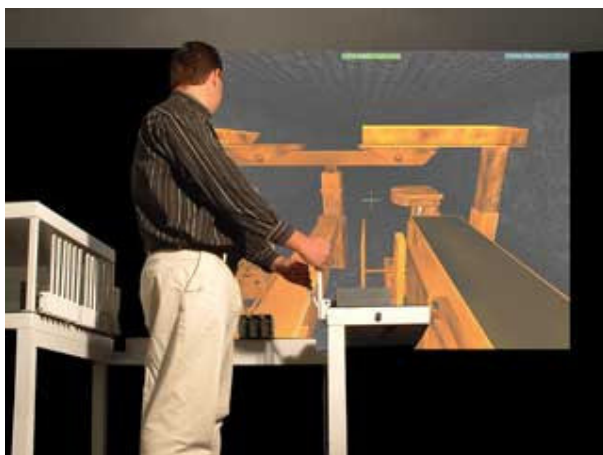
Figur 8. Simulator för bultsättning (Källa 5DT Fifth Dimension Technologies).
