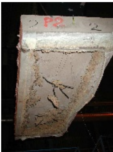
Figur 4: Paneler efter brandtest. Bilden till vänster visar resultatet efter den inledande provningen, all sprutbetong har spjälkat bort. Bilden till höger visar resultatet med nya sprutbetongrecept, ingen spjälkning efter 180 minuter med HC-kurvan.
