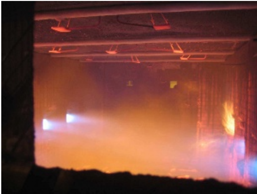
Figur 3: Pågående brandtest i SP:s stora horisontalugn.
