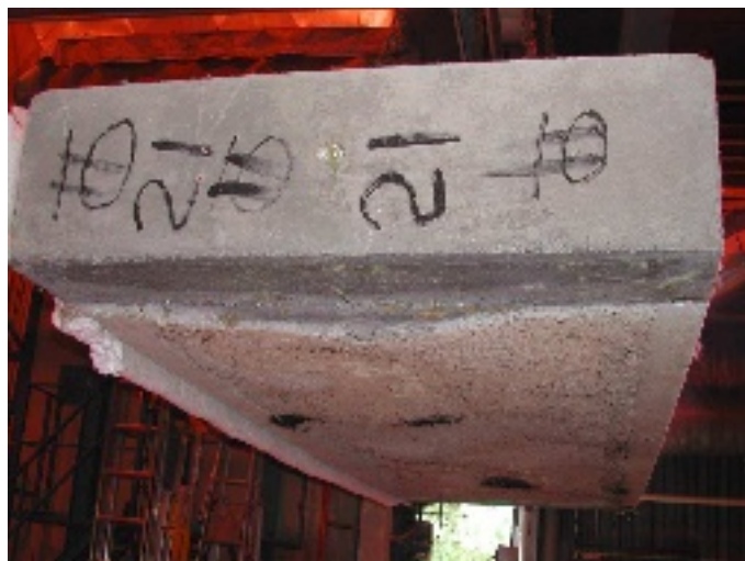
Figur 4: Paneler efter brandtest. Bilden till vänster visar resultatet efter den inledande provningen, all sprutbetong har spjälkat bort. Bilden till höger visar resultatet med nya sprutbetongrecept, ingen spjälkning efter 180 minuter med HC-kurvan.
