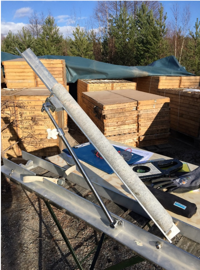
Figur 4. Monterad och orienterad borrkärneställning med en kärnbit placerad för att göra en mätning. På bild strykning 220 och lutning 40. (Foto Hanna Olausson, april 2017)
