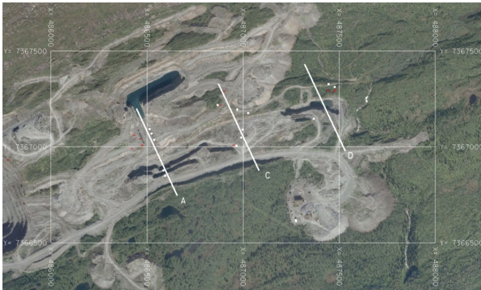
Figur 6. Placering av linjer och mätpunkter för övervakning i dagen.
