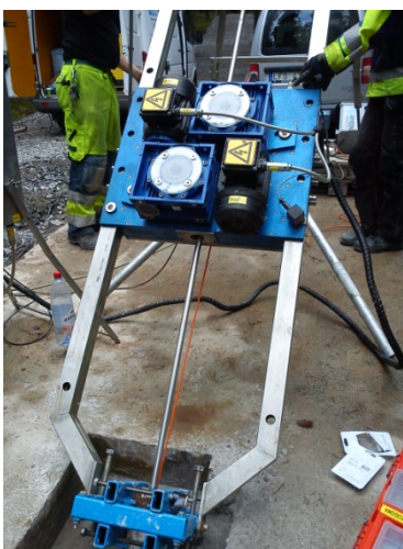
Figur 3-1. Detalj av införselutrustning som användes i samband med BIPS och radarmätningar. Close-up of equipment used for installation of BIPS (Borehole Image Processing System) and borehole radar.
