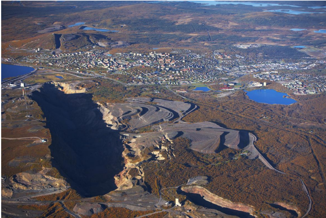
Figur 2 Flygfoto över Kiruna (vy mot norr) med utbildad rasgrop ovanför Kiirunavaaramalmen till väster och befintligt samhälle till öster.
