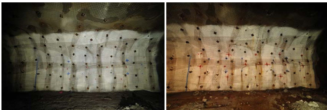
Figur 6. a) Panelen före sprängningen, b) Begränsade skador efter sprängningen. a) The panel before and b) after blasting. Foto av Nordqvist, LKAB.
