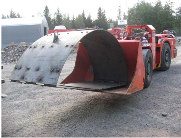
Figur 5. Ett sködelement med infällda väggar färdigt för transport till rasplatsen
