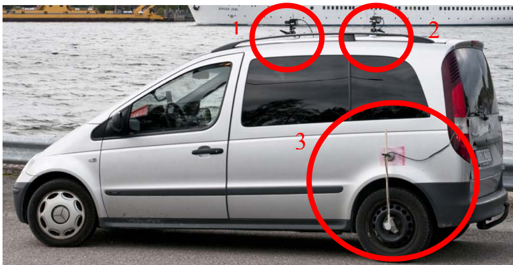
Figur 1 Specialutrustad bil med 1) Framåtriktad filmkamera 2) Sidoriktad kamera för fotografering av bergskärning och 3)måthjul för kontinuerlig längdmätning. . I bilen finns även monterat GPS som är kopplad till dator och loggerutrustning. Vehicle equipped for surveying road cuts.
