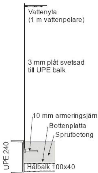
Figur 3. Tvärsnitt av provlåda. Betongformen utfördes med UPE balkar som förstärktes med hålbalkar för att minska deformation från krympning
