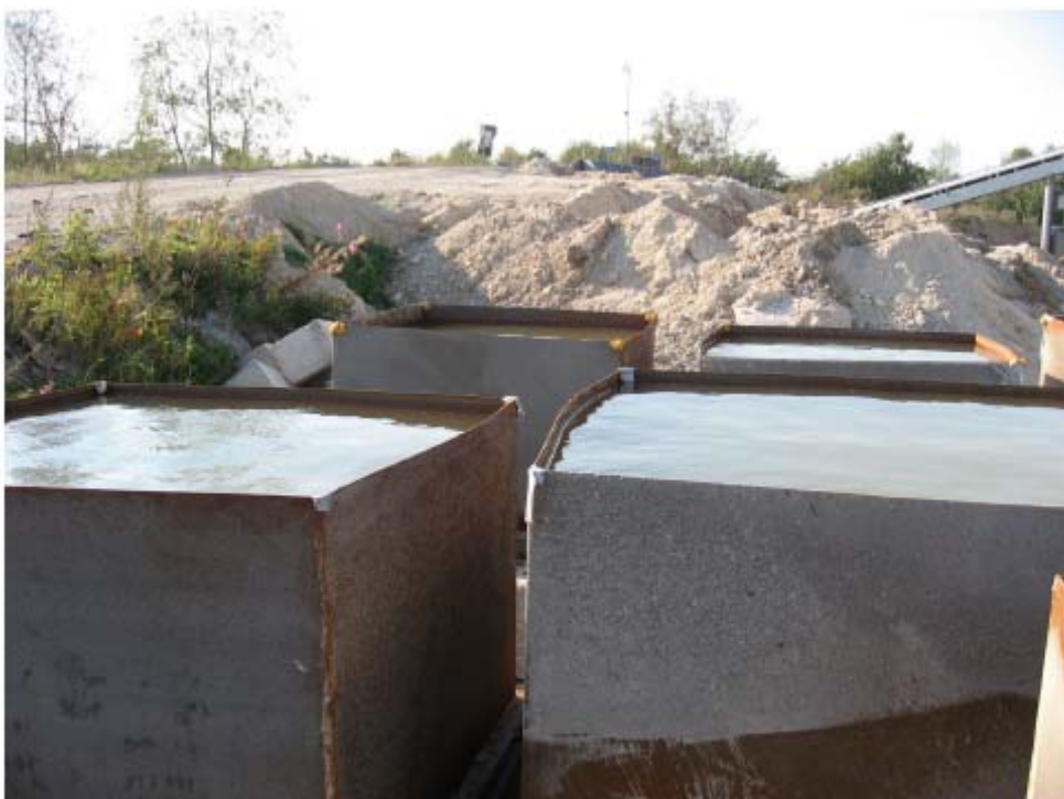
Figur 4. Full vattenbelastning med 1 m vattenpelare
