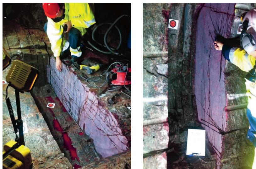
Figur 5 Kartering av spränginducerade sprickor. TAS04, sektion 34 till vänster och sektion 12 i TASN till höger. Mapping of blast induced fractures in TAS04 and TASN.
