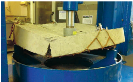
Figur 5. Provtryckning av en 100 mm tjock betongplatta med underliggande stålnät, från Thyni (2014).
