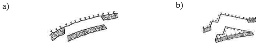
Figur 3 Utfall av sprutbetong och berg [10]. Fallout of shotcrete and rock [10]. a) Utfall av enbart sprutbetong b) Utfall av berg och sprutbetong
