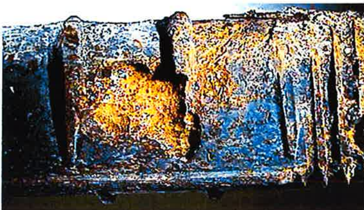
Figur 6. Allmänt angrepp i det fallet att ytan utan bruk varit större än 0,5 \text{ cm}^2 . Bult 29.
