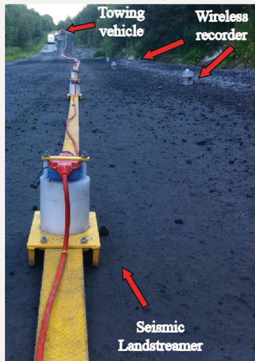
Figur 1. Landstreamern dras av en bil längs en grusväg och trådlösa enheter är placerade vid sidan av vägen.
