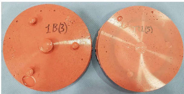
Figur 25. Gjutform med styrtapp (till vänster) och med styrtappen avlägsnad (till höger).
