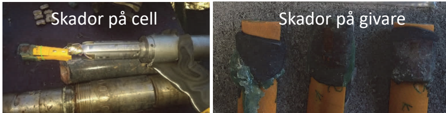
Figur 17. Exempel på bedömningen "mycket otillförlitlig" på grund av stor påverkan på mätcell och givare.
