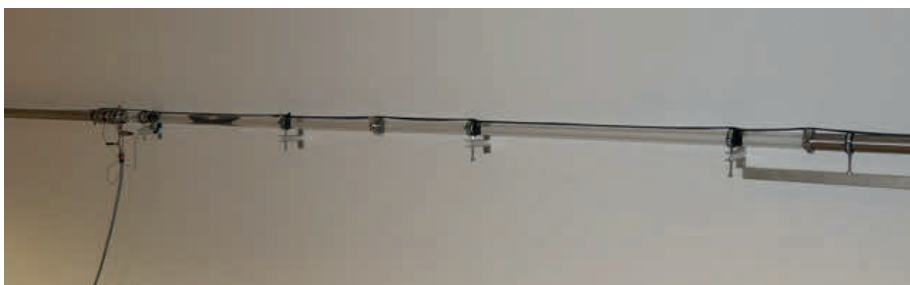
Figur 11. 4 m genomskinligt polykarbonatrör inkopplat i systemet följt av 6 m rostfritt rör. 4 m transparent simulator tubing made from polycarbonate tubing connected to the system and followed by 6 m stainless steel tube.
