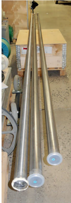
Figur 10. Tre 6 m långa rostfria rör som medger att simulatorens byggs ut till 24 m. Three 6m long stainless steel pipes allowing a total simulator length of 24 m.
