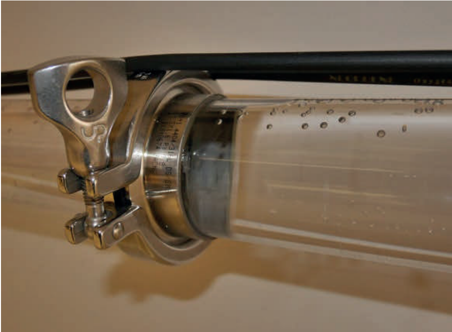
Figur 12. Polykarbonatrör med pålimmad TC-hylsa kopplat till simulatören. Polycarbonate tube with a glued TC flange connected to the simulator.
