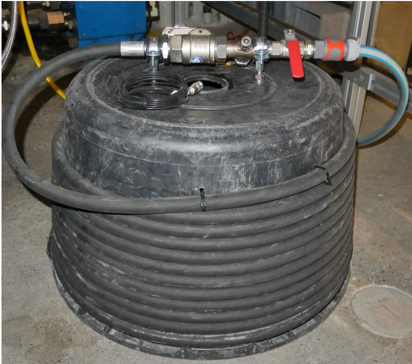
Figur 47. Anordning för att mäta tryckvariationer när tryckvågor passerat 20 m stålärmerad gummislang snarlik injekteringsslang. Device for measuring pressure variations when pressure waves passed a 20 m long hose.
