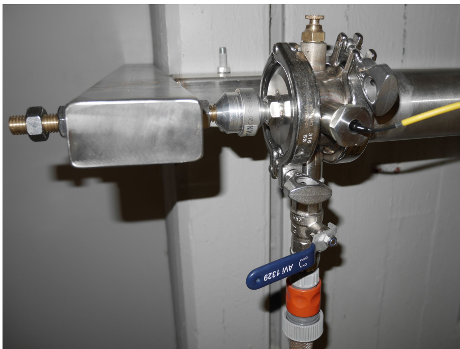
Figur 22. Utloppet från borrhållsimulatorn. Mothåll, kraftgivare, luftningsventil, hydrofon, kulventil. Outlet from the simulator tube. Anvil, force transducer, air-vent, hydrophone and ball valve.
