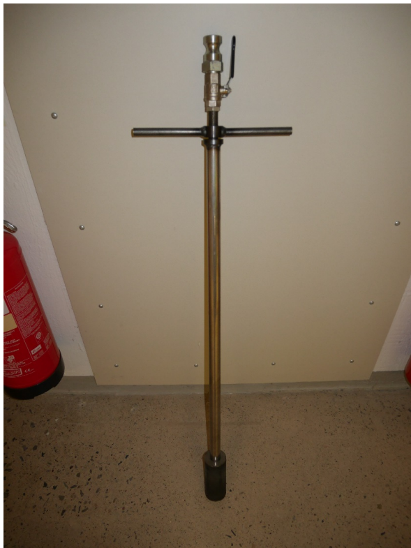
Figur 13. Injekteringsrör med packer, spännhandtag, kulventil och slangkoppling. Grouting pipe with packer, handle, ball valve and hose coupling.
