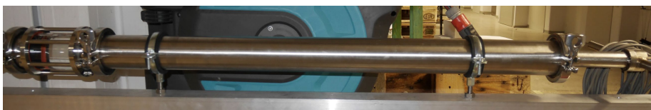
Figur 14. Ytterrör till injekteringsröret ger stöd och medger förskjutning av packerns placering relativt simulatorröret. Cover tube for the grouting pipe which provides support and allows the packer position to be adjusted relative the simulator.
