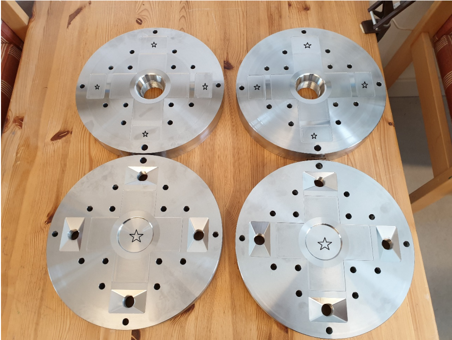
Figur 19. De två korta spalterna tillverkade på uppdrag av KTH och LTH. De innehåller 8 olika spaltvidder från 40 till 140 \mu\text{m} . Ytterdiameter 300 mm. Two "kort spalt" devices with thresholds of 40 to 140 \mu\text{m} . Outer diameter 300 mm.
