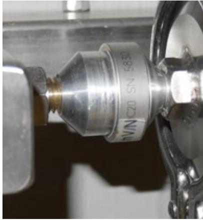
Figur 23. Kraftgivaren vid rörslut / utlopp. Force transducer at the end of the tube.
