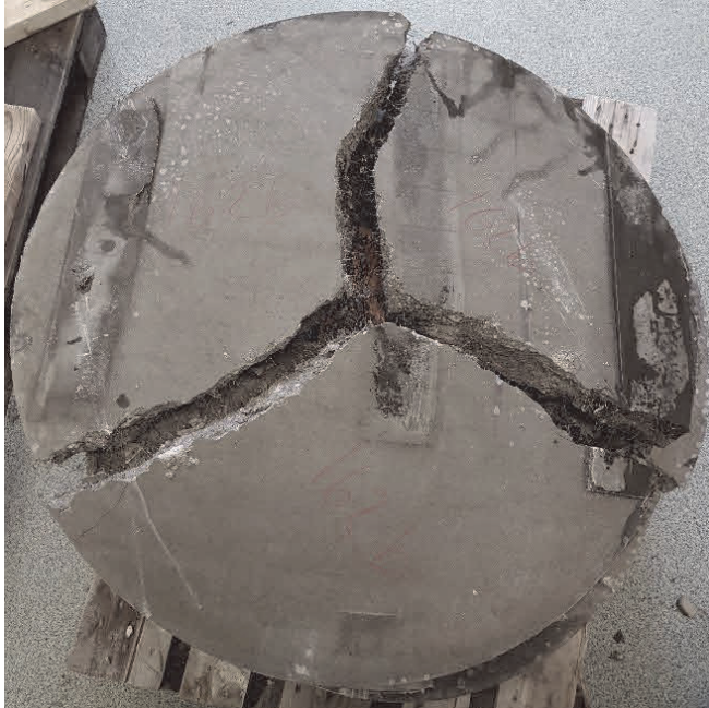
Figur 2. Böjprovad rund sprutbetongplatta med utstickande stålfibrer i brottsprickorna. Från ElZain (2018).
