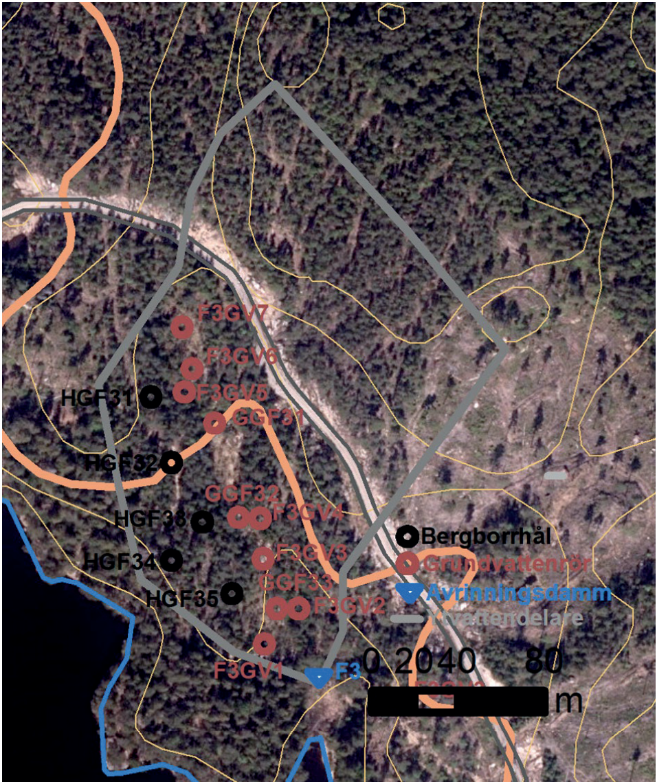
Figur 2. Flygbild över försöksområdet (F3) med markerade bergborrhål, grundvattenrör, avrinningsdamm och tolkad ytvattendelare.
