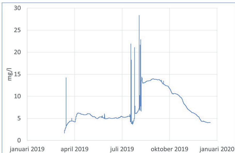
Figur 18. Beräknad koncentration av sulfat i avrinningsvattnet baserat på regressionsanalys och loggermätning av elektrisk konduktivitet. Koncentrationen sulfat beräknas ha stigit i samband med att avrinningsflödet ökade i slutet av torrperioden 2019.
