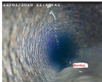
Figur 10.9. Hål nr.23, borrkax i nedåtriktat hål. Figure 10.9. Hole No. 23, drill dust in downward hole.
