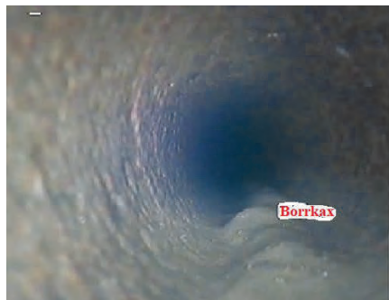
Figur 5. Hål nr 24, borrkax i nedåtriktat hål. Figure 5. Hole No. 23, drill cuttings in downward hole
