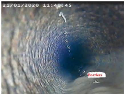
Figur 4. Hål nr 23, borrkax i nedåtriktat hål. Figure 4. Hole No. 23, drill cuttings in downward hole
