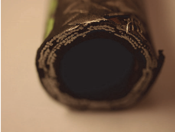
Figur 106. Slang med innerdiameter 1/2". Två lager stålkor krysspunnet. The two layer steel cord of the ID 1/2" tube.
