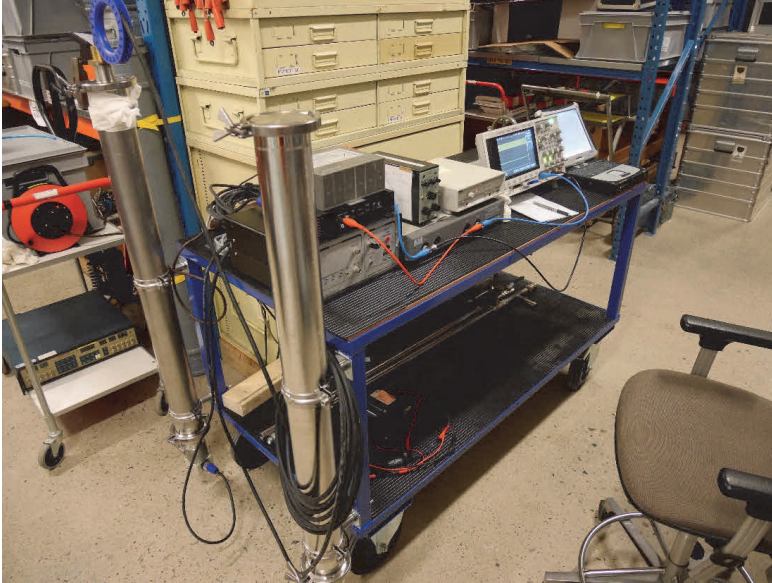
Figur 2. Resonanskamrarna uppkopplade med olika sändare i nedre delen. Det borte röret har en hydrofon som återkopplar svängningarna i röret, vilket gör att den dominerande tonen tar över. Denna hydrofon flyttas mellan rören. Equipment for feedback resonance experiments.
