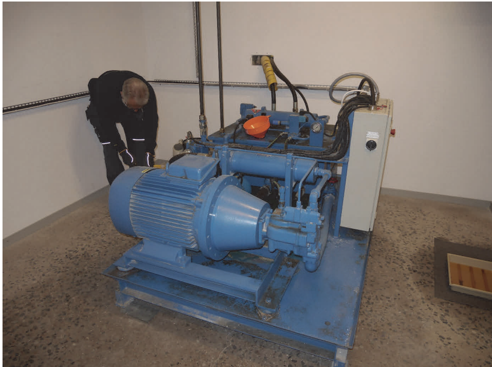
Figur 4. LTH:s största hydraulpump 220 bar och 90 l/min. The largest hydraulic pump available at LTH.
