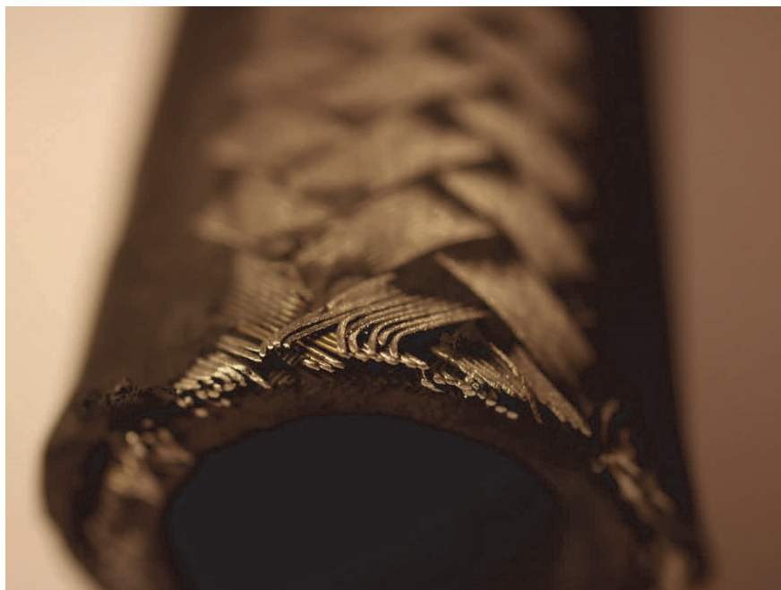
Figur 103. Slang med innerdiameter 3/4". Ett lager stålkord krysspunnet. The single layer steel cord of the ID 3/4" grouting tube.
