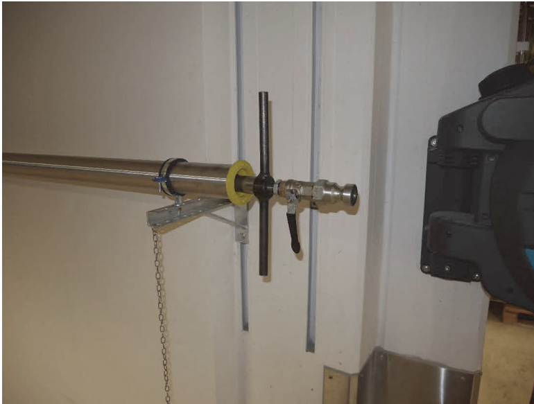
Figur 31. Borrhålssimulaton bestående av 2 st 6 m långa rostfria rör med diametern 63.5 mm med instucket och med handtaget fastspänt injektionsrör. Injection tube installed in the drill hole simulator using a packer.
