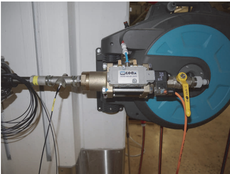
Figur 32. Elektropneumatiskt styrd koaxialventil för generering av tryckslag. Den är kopplad direkt till ett injektionsrör inskjutet i det rostfria röret, tätat med en konventionell expander, sk "packer". The coaxial valve mounted on the injection tube.
