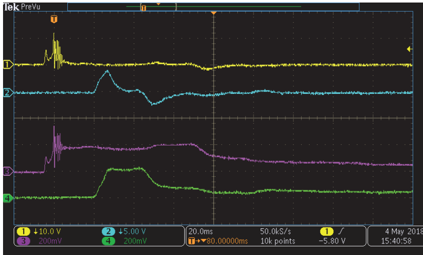
Figur 97. TEK00041. Ventilen öppnar. Fullt flöde. Detaljstudie. Hydrofoner (1,2) och tryckgivare (3,4). Distorderade hydrofonsignaler beroende på impedansmissanpassning. Kanal 2 ser därför ut som derivatan av kanal 4. Distorted hydrophone signals due to an impedance mismatch to the scope.
