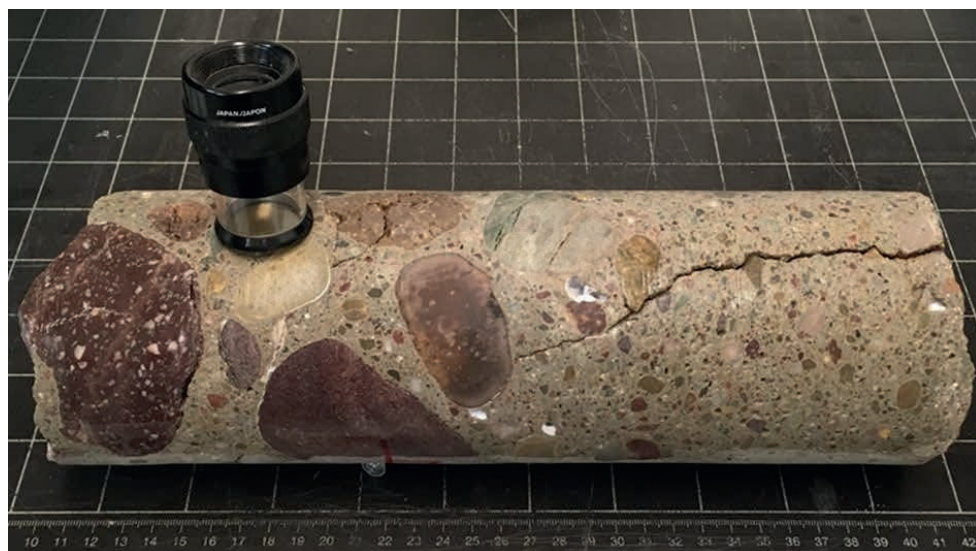
Figur 1. Okulär granskning av en borrkärna med hjälp av lupp. Luftporer är fyllda med vit alkalisilikagel och ballast visar sprickor karaktäristiska för ASR.
