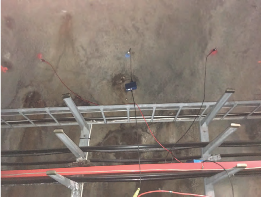
Figur 69. En mätgrupp Elektrod – Geofon – Elektrod. Dessa grupper sitter på 1 m inbördes avstånd. Mitt emellan mätgrupperna placeras skottpunkterna.
