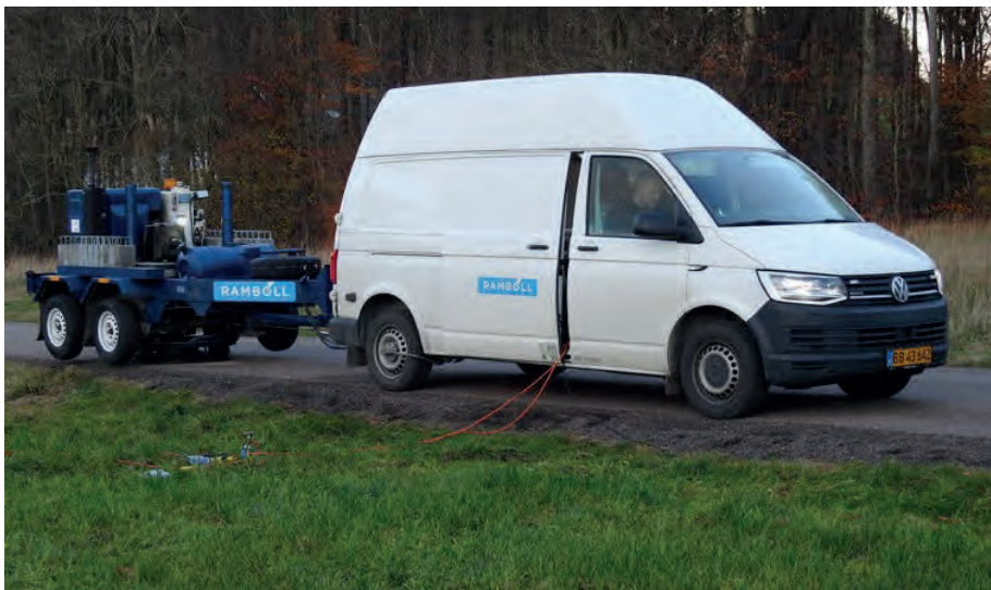
Figur 3. Seismisk vibrator använd i försöken, här vid plats 12. De röda kablarna är kabelstammarna som vardera går ut till 16 förförstärkare med 16 elektriska dipoler, dvs dubbla jordspett, och 16 förförstärkare med geofoner samlokaliserade med dipolerna.
