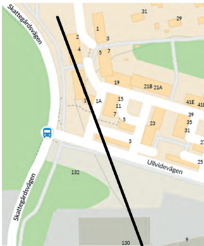
Figur 57. Svaghetszonen inritad på fastighetskartan. Väster om Skattegårdsvägen är terrängen starkt kuperad och inte lämpad för mätningar, se Figur 58 nedan. Ett lämpligt ställe att utföra mätning är omedelbart söder om Ullvidevägen och längs denna.
