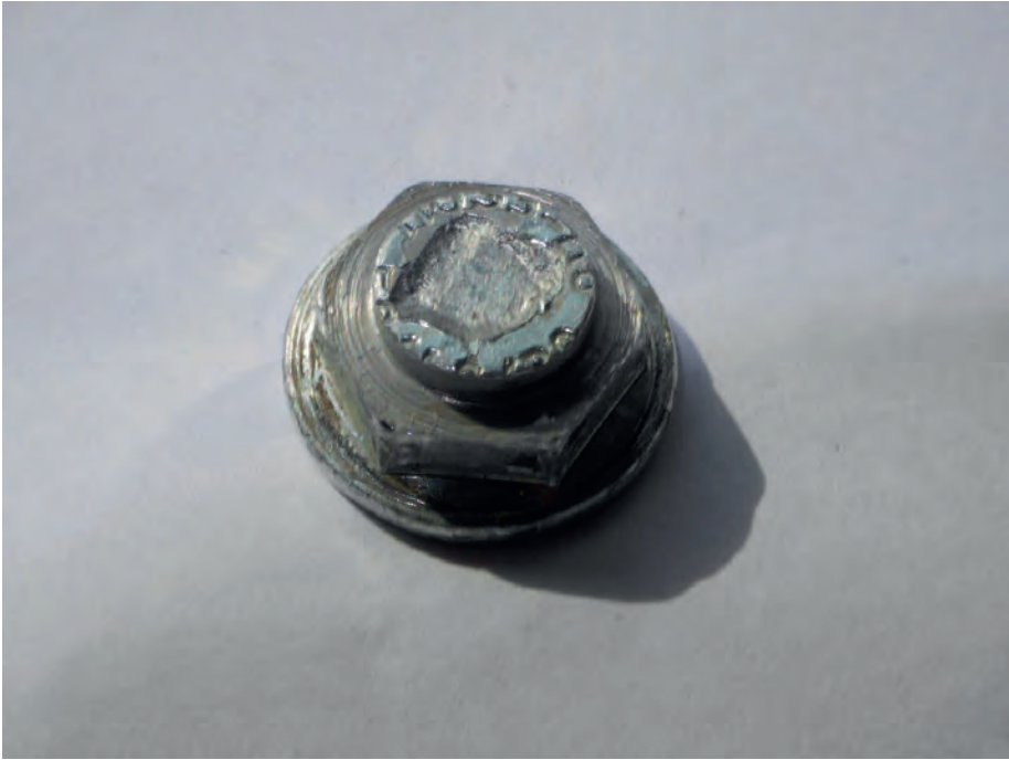
Figur 74. Skallen på den nedsvavade bergskruven efter ett bultpistolskott. Fördjupningen är det avtryck som bultpistolens pistong alstrar.
