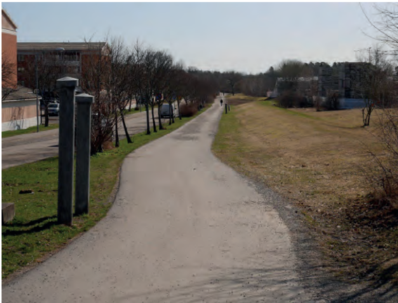
Figur 154. Lämplig placering av vibratorn är på den asfalterade cykelstigen/gångbanan och elektroder kan placeras i gräsmattan till höger om denna. Till vänster om gångbanan, närmast i bild, är en fjärrvärmekulvert förlagd och till höger finns en långsträckt vall, vars innehåll visade sig svårutrett. En bit ner längs Ullvidevägen byter fjärrvärmekulvertens sida om gångbanan. Detta sker där ventilationsrören syns mitt i bilden, 30% uppifrån i bild.
