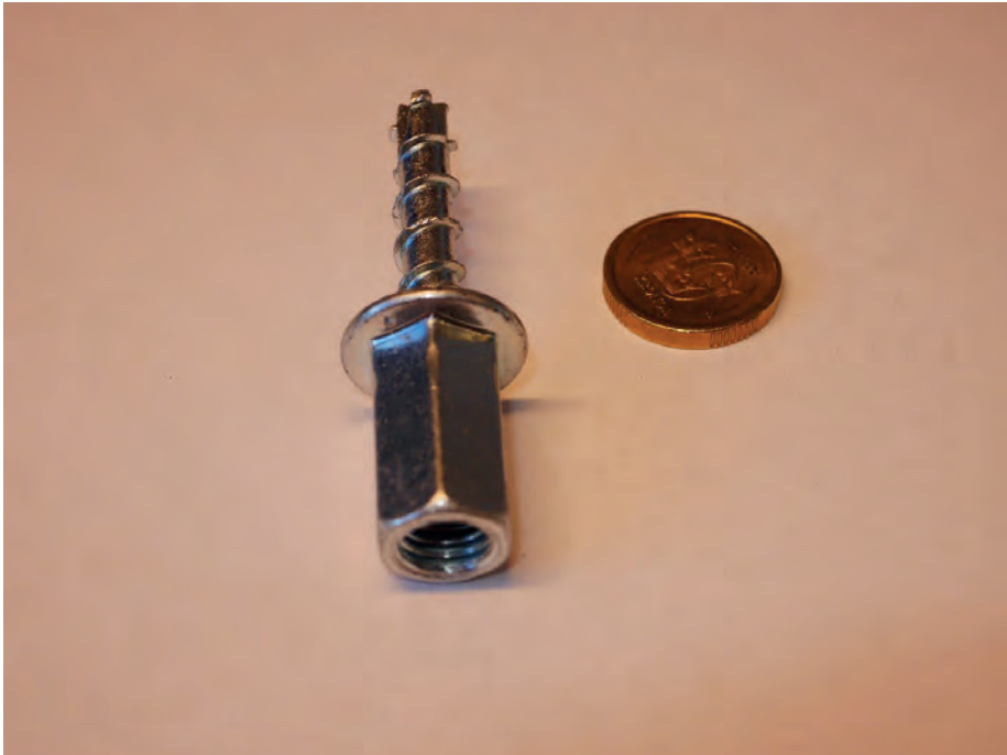
Figur 66. En sådan skruv som används som elektrod. En klämma anbringas kring den utskjutande delen. Skruven gängas in i ett förborrat hål med hjälp av mutterdragare.
