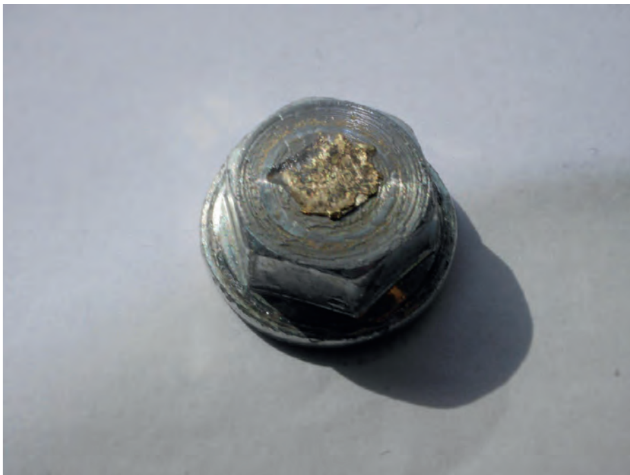
Figur 73. Visar kvarvarande rester av mässingsknoppen efter ett skott från bultpistolen.
