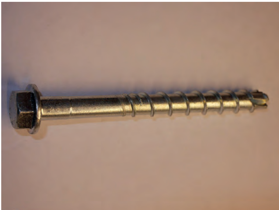
Figur 71. Då det, i föregående mätning, uppstod tvekan om energiöverföringen från bultpistol till berg när sprutbetonglagret var tjockt användes 100 mm långa bergskruvar. Dessa går genom sprutbetongen och in en bit i berget.
