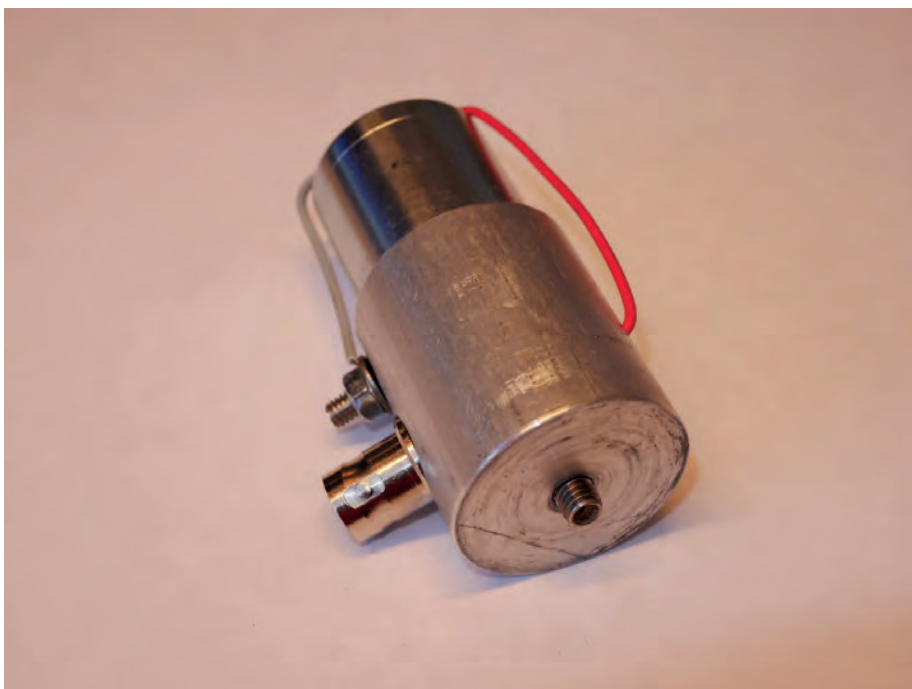
Figur 68. En sådan geofon som använts vid mätningarna. Den har en skruv M5 för fastsättning mot skruven i berget.
