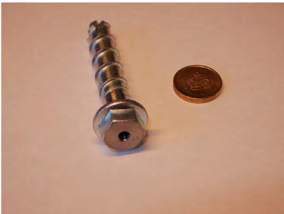
Figur 67. En sådan skruv som används för infästning av geofonerna. Den har ett gängat hål M5 för fastsättning av geofonen.
