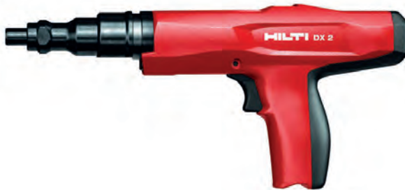
Figur 70. Den använda typen av bultpistol. Vid mätningarna används inga bultar i pistolen utan den pistong som normalt driver in bultarna får slå direkt mot skruvarna som är fastsatta i berget.
