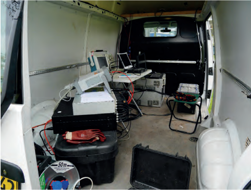
Figur 120. Instrumentuppställning inuti Rambölls skåpbil, som också fungerar som dragbil till vibratorn.
