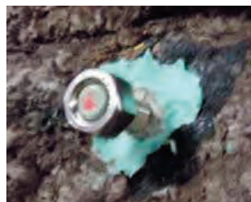
Figur 7. Tätning av spalt mellan cementcylinder och berg
