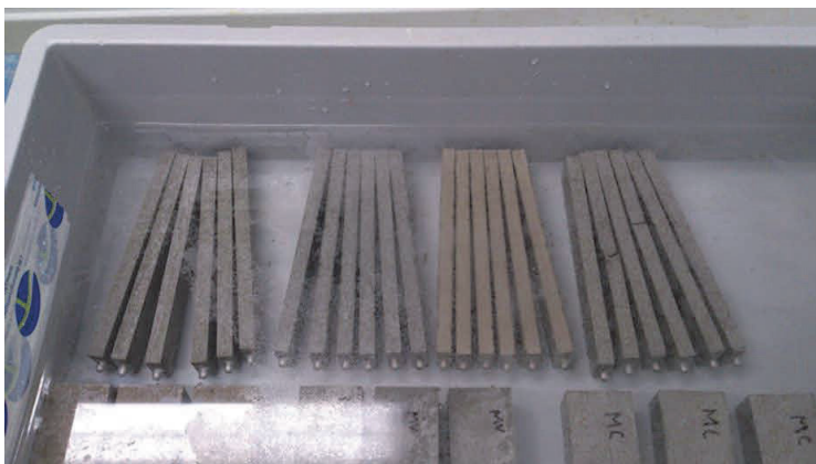
Figur 7-1 Indränkningstester (Immersionstester) av olika bruksprismor i sulfatlösningar.
