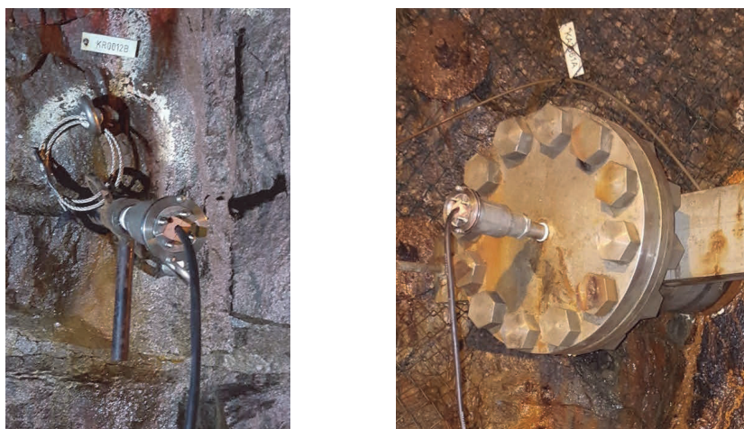
Figur 9-3. Borrhål med installerade prover och korrosionsgivare. Till vänster: borrhål B. Till höger borrhål A.
