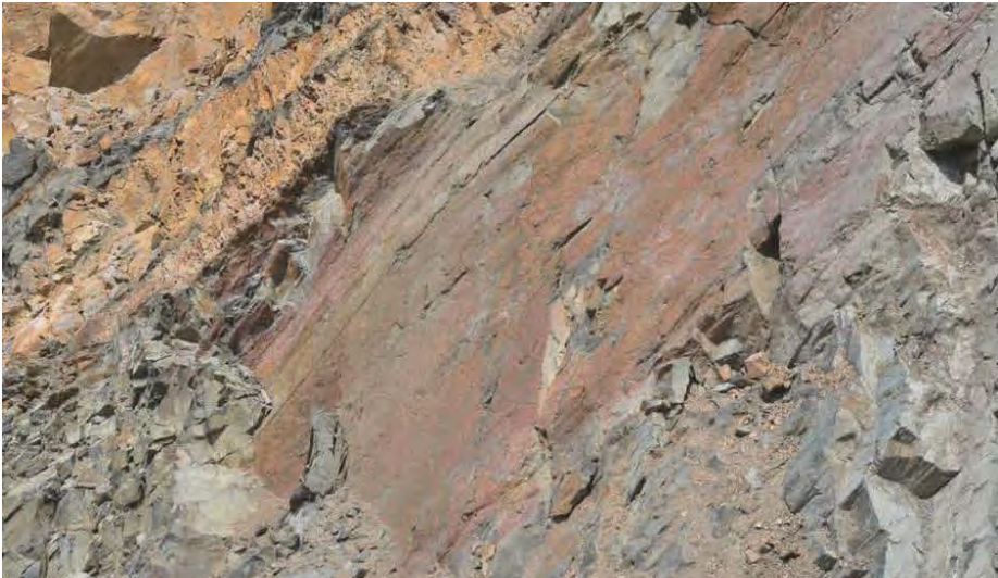
Figur 35 Omfattande röd hematitbildning i en amfibolit. Hematiten förekommer i relativt sammanhängande ytor.
