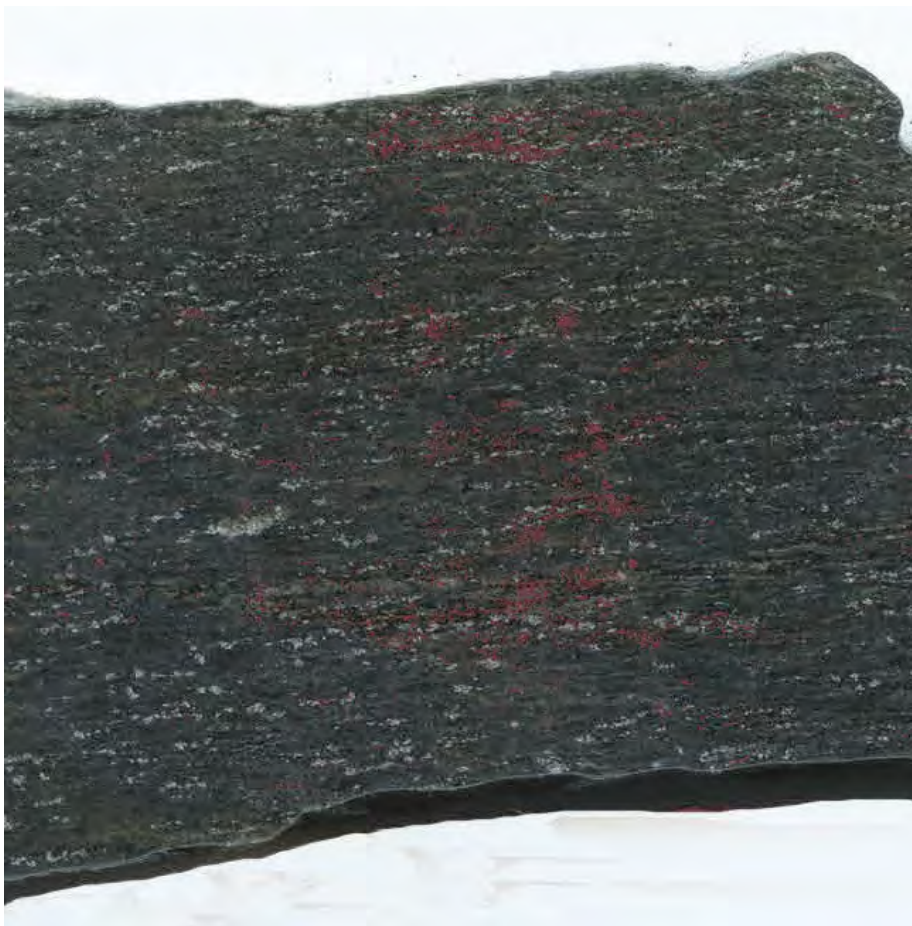
Figur 36 Hematit förekommer inte bara som sammanhängande skikt i amphiboliten utan även inne i amphiboliterna som enskilda mineralkorn. De är delvis parallella med foliationen. I bilden har hematitens röda färg förstärkt för att öka åskådligheten. Bildens bredd är ca 7 cm.
