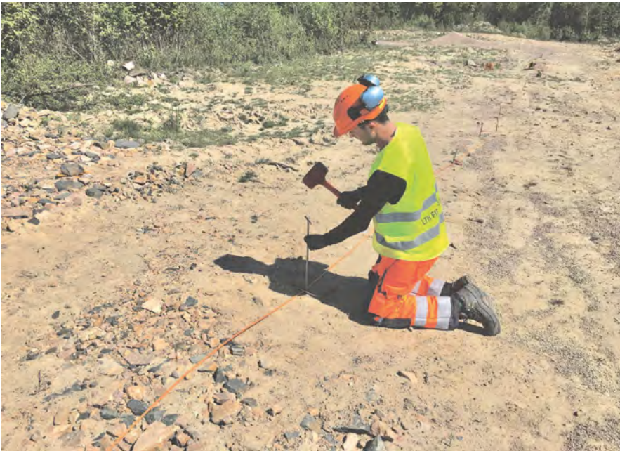
Figur 14 Elektroder för DCIP-mätningen hamras ner i den ännu inte avbanade moränen.
