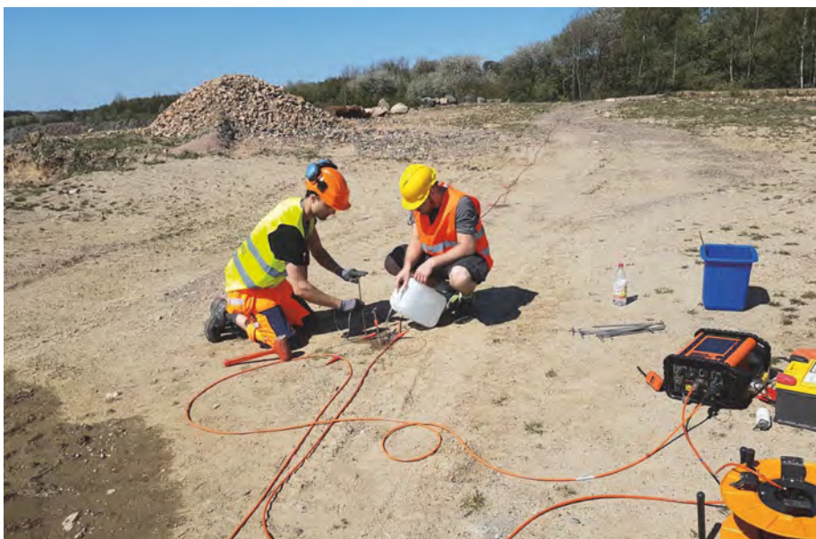
Figur 3 Mätning av resistivitet och IP. Under vissa förhållanden är övergångsmotståndet mellan elektroderna och materialet i markytan högt. Detta kan motverkas med vätska, som hölls ur dunken.
