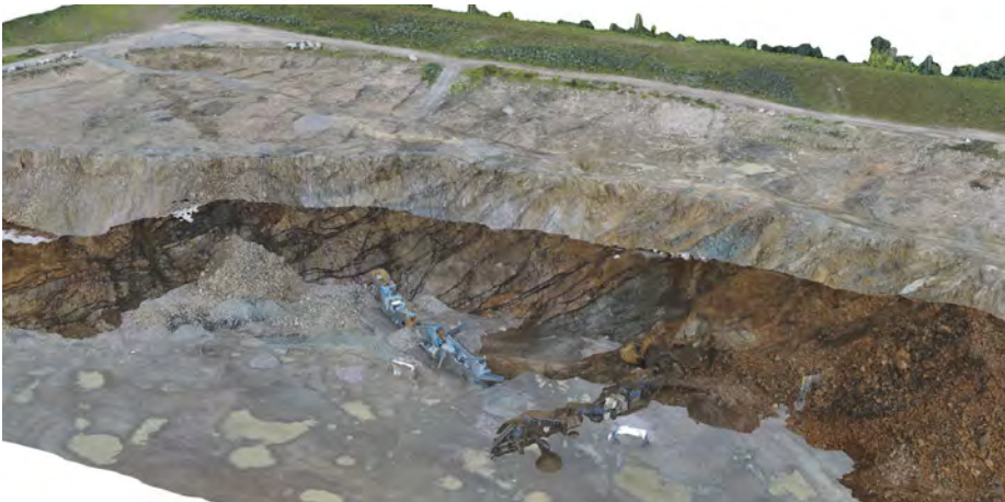
Figur 22 En kombination av de bägge terrängmodellerna ovan (Figur 20, Figur 21). Den geofysiska volymen ligger i huvudsak mellan de bägge avbildade bergskärningarna.
