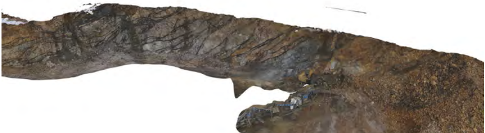
Figur 20 Tredimensionell datormodell, terrängmodell som visar bergväggen i projektets inledning (oktober 2016), innan skärningen kommit in i den geofysiska volymen.
