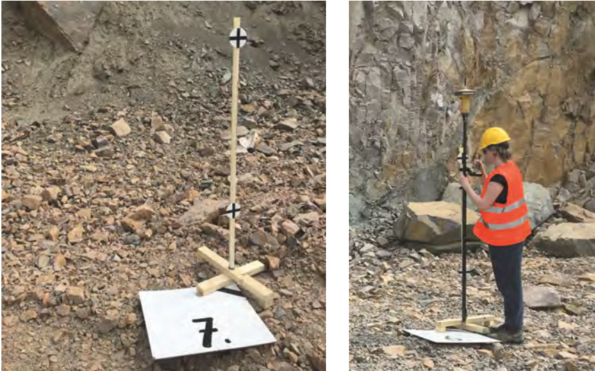
Figur 16 Signaler som använts för georeferering i de tredimensionella terrängmodeller som skapats med hjälp av drönarfotografering. Till vänster ses signalen, som mäts in i plan och höjd med GNSS (till höger). Avståndet mellan marken och markeringarna på stången ("+") är lika för alla signaler.
