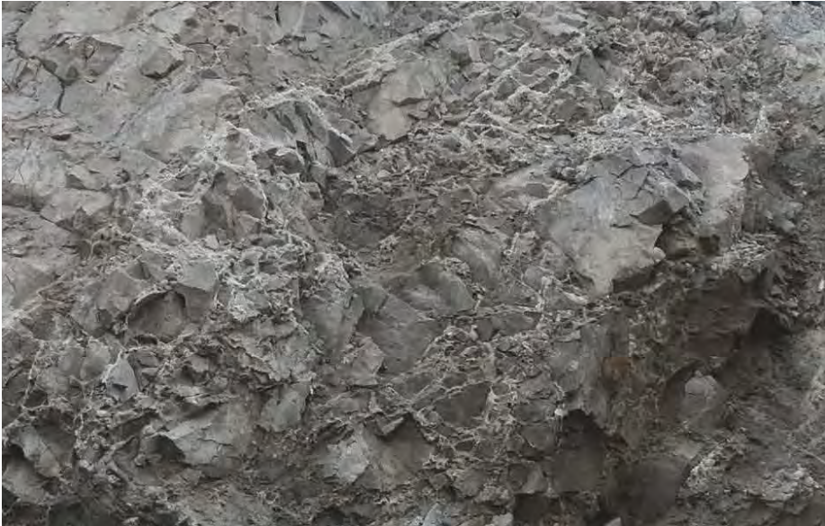
Figur 30 Bilden visar en starkt uppsprucken breccia där sprickorna mellan gnejsfragmenten läkts av kalcit. Bildens bredd ca 3 m.
