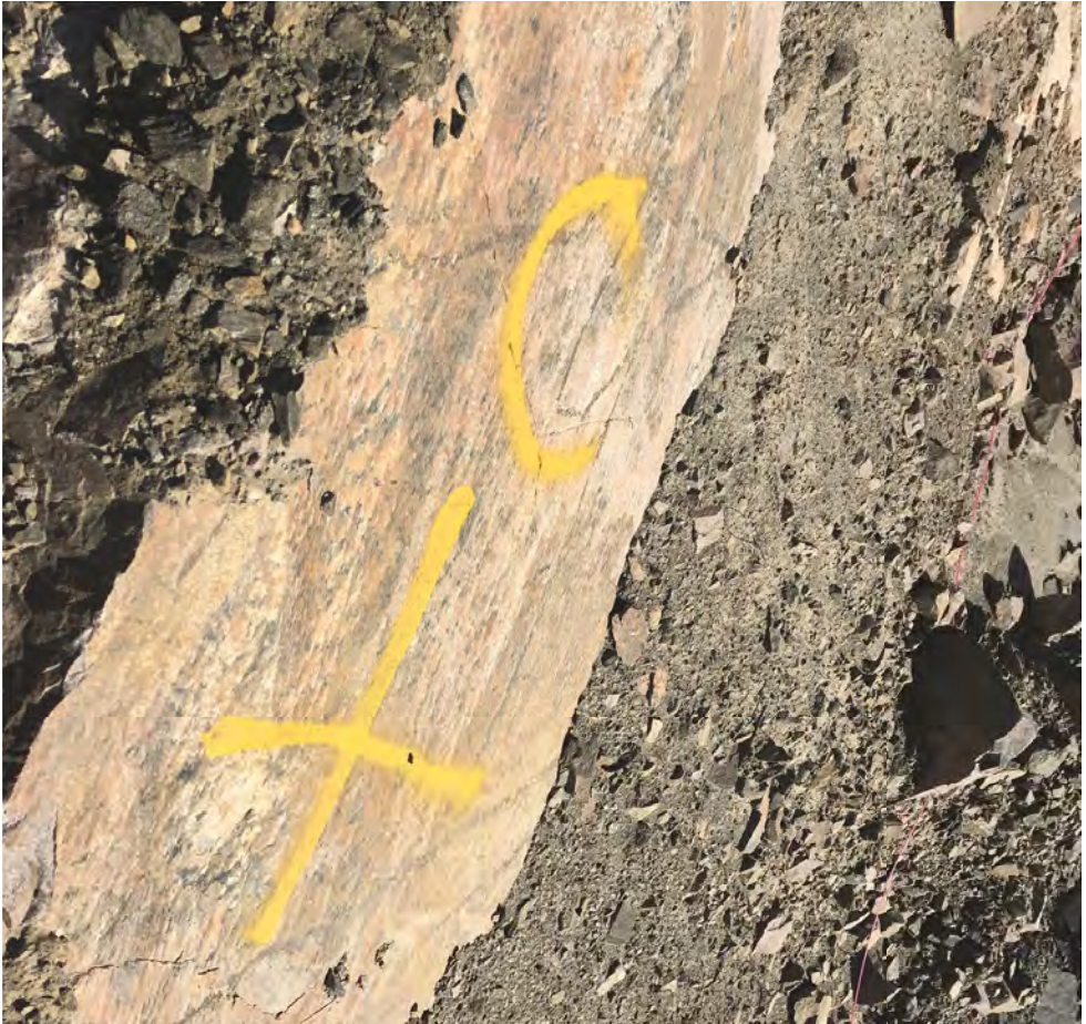
Figur 12 Markering på bergvägg som används för att georeferera panoramabilderna samt som referens och kontroll i de tredimensionella modellerna från drönarfotografering.
