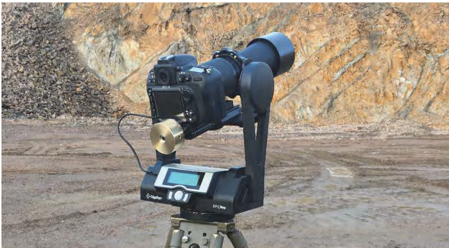
Figur 5 Fotografering med ett robotiserat panoramahuvud (GigaPan Epic Pro, www.gigapan.com ). Kamerans rörelser programmeras in genom att bland annat önskat utsnitt i det färdiga panoramat definieras med hjälp av kamerans sökare. Roboten genomför sedan fotograferingen automatiskt. Mässingsvikten är en modifiering av originalutförandet, för att balansera det relativt tunga teleobjektiv som används vid detta fotograferingstillfälle.
