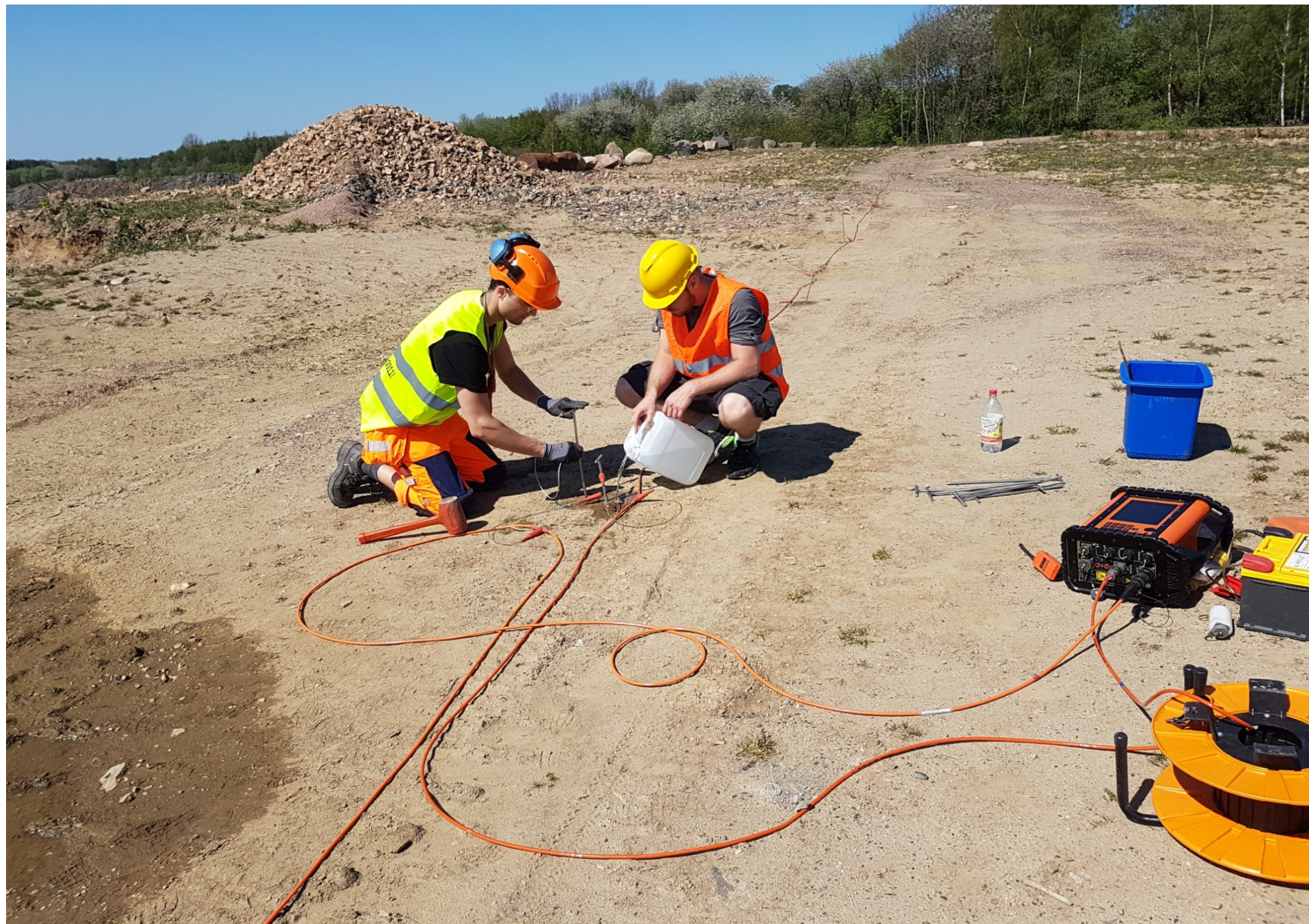
Bilden visar en geoelektrisk undersökning i Dalby stenbrott
