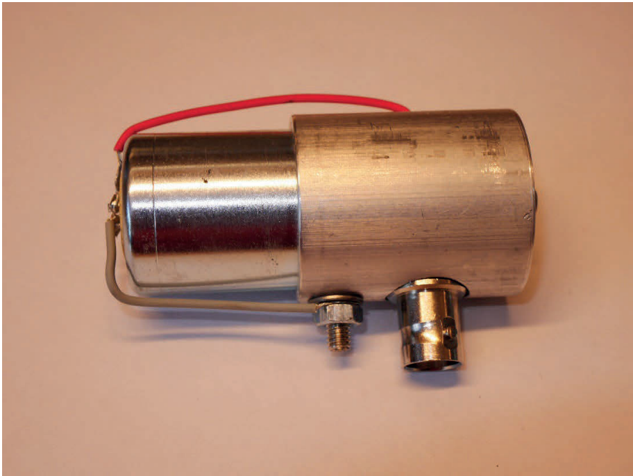
Figur 1. En geofon i entums standardkapsling försedd med en aluminiumfot som medger inkoppling av kabel samt montering på underlag med M5 skruv.
