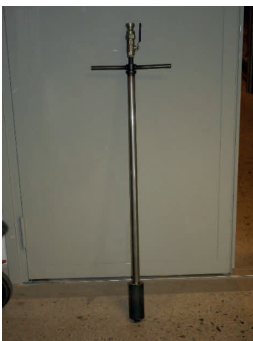
Figur 12. Packer. Genom att vrida på handtaget förorsakar man att gummicylindern nedtill expanderar och tätar mot borrhålets vägg.
