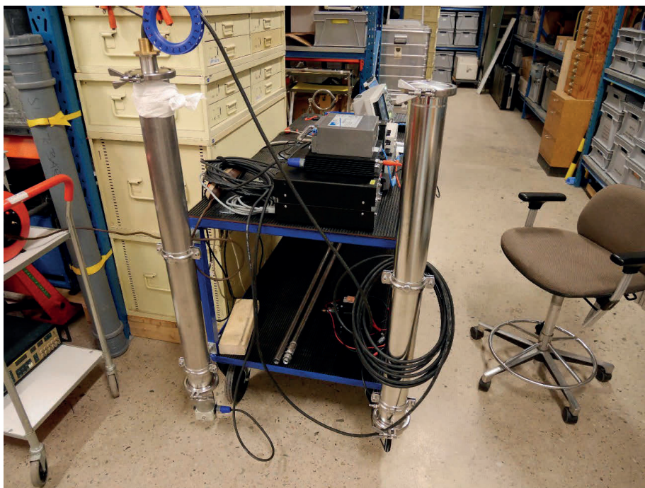
Figur 17. Resonanskammare monterade vertikalt på försöksvagnen. T.v. sitter Motran vibrationskälla nedtill och kulhydrofonen upptill och till höger 118 kHz ekolodkälla nedtill. Vid mätning med den senare flyttas kulhydrofonen.
