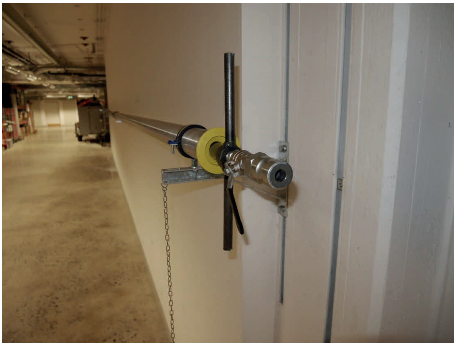
Figur 15. Borrhålssimulator avseende resonansegenskaper. Två hopkopplingsbara rostfria rör med OD 63.5 mm, vardera med längden 6 m. I ena änden ansluts injekteringsröret med hjälp av en packer (hiterst i bild), se Figur 12.
