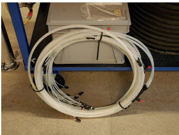
Figur 14. Impedanssimulatorns utseende i hoprullad form. I varje förgreningspunkt kan trycket mätas.
