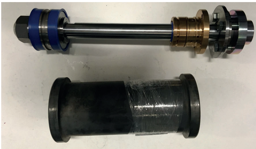
Figur 43. Kolv, kolvstång och cylinder från Epirocs injektionspump. Cylinderdiametern är 80 mm.
