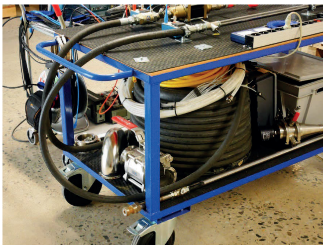
Figur 32. 20 m injektoringsslang som tryckslaget utbreder sig i när man vill ta reda på utbredningshastigheten i denna typ av slang.
