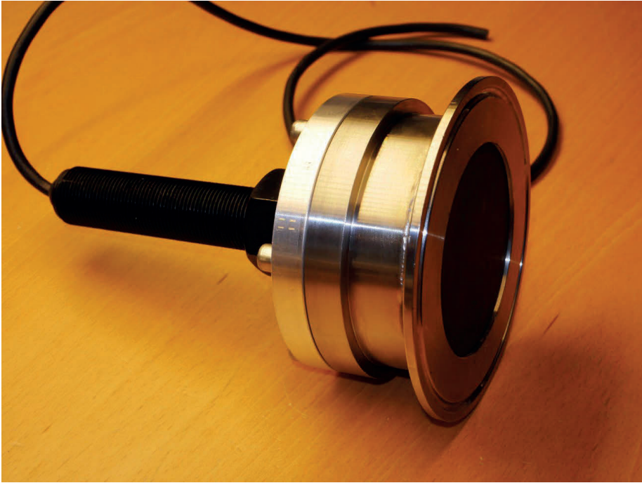
Figur 3. Piezoelektrisk ljudkälla 118 kHz avsedd för användning i ekolod. Anpassning till mejerirör-systemet.
