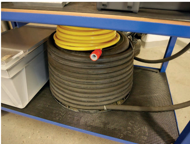
Figur 25. 20 m injekterings slang ihoprullad på av en upp och nedvänd brukbalja. Den gula slangens har inget med försöket att göra.
