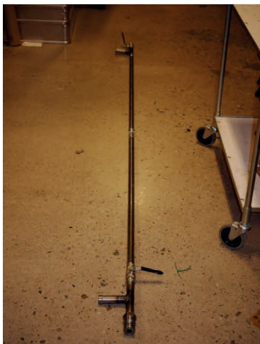
Figur 11. Två ihopmonterade 1 m injekteringsrör försedda med T-kopplingar för mätändamål och kulventiler för reglering av flöde.
