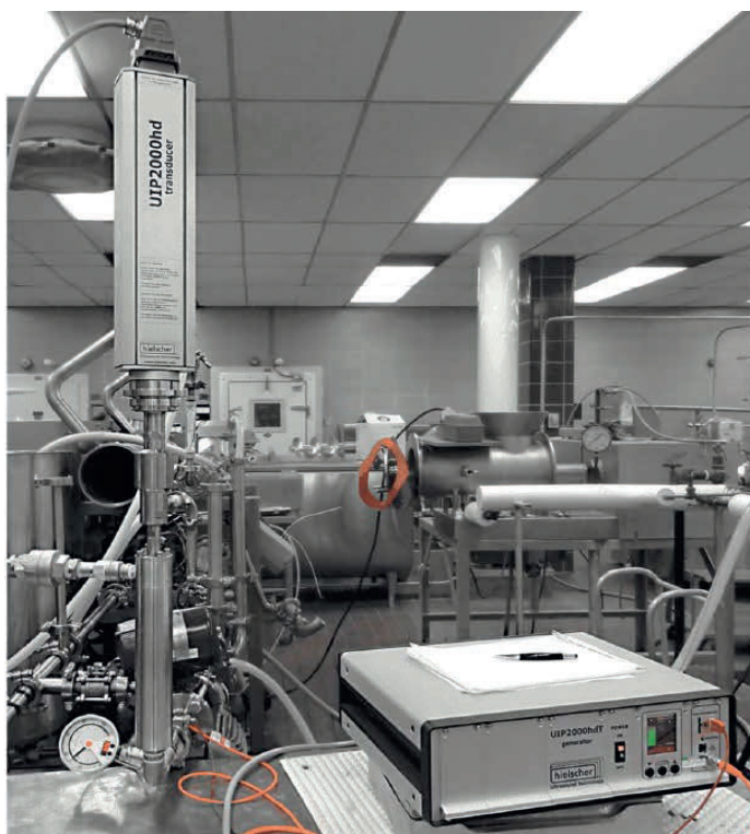
Figur 46. Utrustning för ultraljudsdispergering. Överst till vänster ultraljuddelen, under denna själva dispergeringskammaren och nere till höger kontrollenheten till ultraljuddelen. Det aktuella systemet arbetar vid frekvensen 40 kHz.
