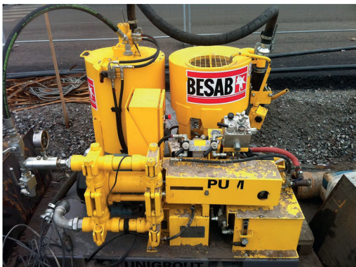
Figur 44. PUMPAC injektionspump. De i projektet använda delarna finns i det grova röret nere till vänster i bilden. Cylindern omges av ett batteri backventiler, vilkas uppgift är att kontrollera flödet under kolvens fram- och återgående rörelser.
