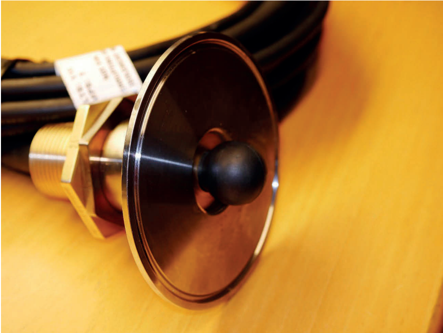
Figur 6. Kulhydrofon med modifierad blindplugg för anbringning mot rörsystemet.
