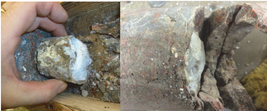
Figur 2-6 Vänster: injekteringspluggen med kanal som slutar. Höger, ihop pusslad borrkärna som visar sprickan som er upphov till kanalen i injekteringspluggen.
