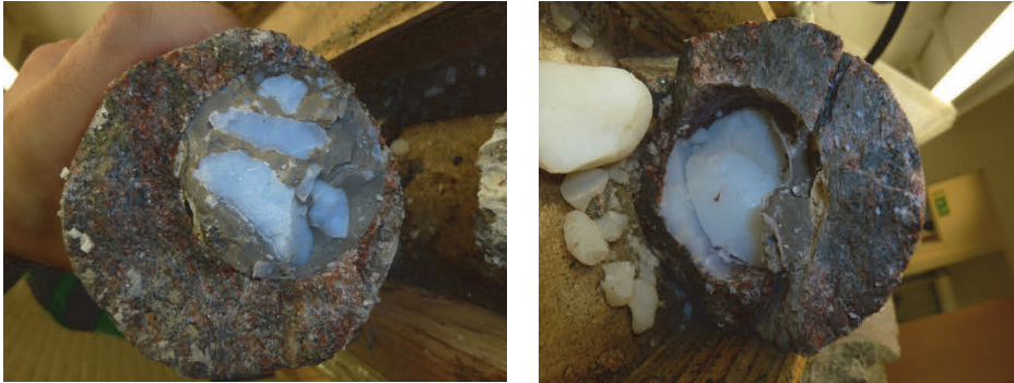
Figur 2-5 Vänster: Bild tagen på kärnan vid 3,3 m djup från överborrningen. Höger: bild vid 2,3 m längd. Både cement och silica sol ihop blandat återfinns. Kanalen som syns i cementet (ungefär vid klockan 9 i vänstra bilden och klockan 3 i högra) är den som transporterar vatten fram till öppningen på borrhålet. Kanalen har dock kalcitutfällningar och i vissa delar av kärnan i omfattande mängd..
