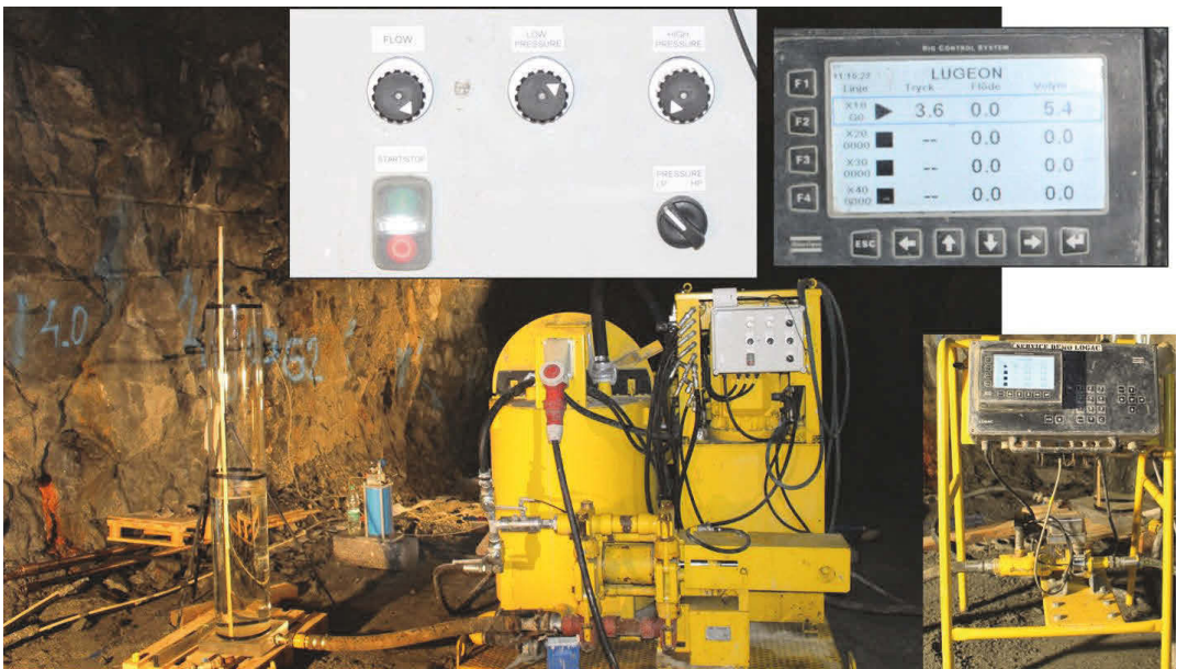
Figur 6: Unigrout, injekteringsrigg från Atlas Copco.
