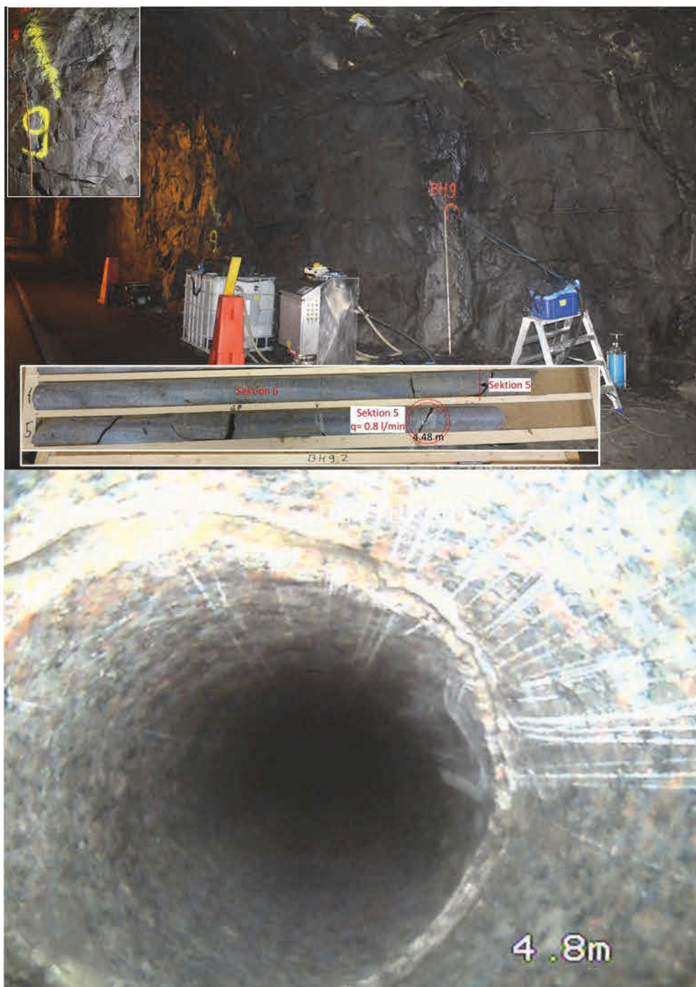
Figur 24: Transmissivitetmätningar av borrhål BH9.
