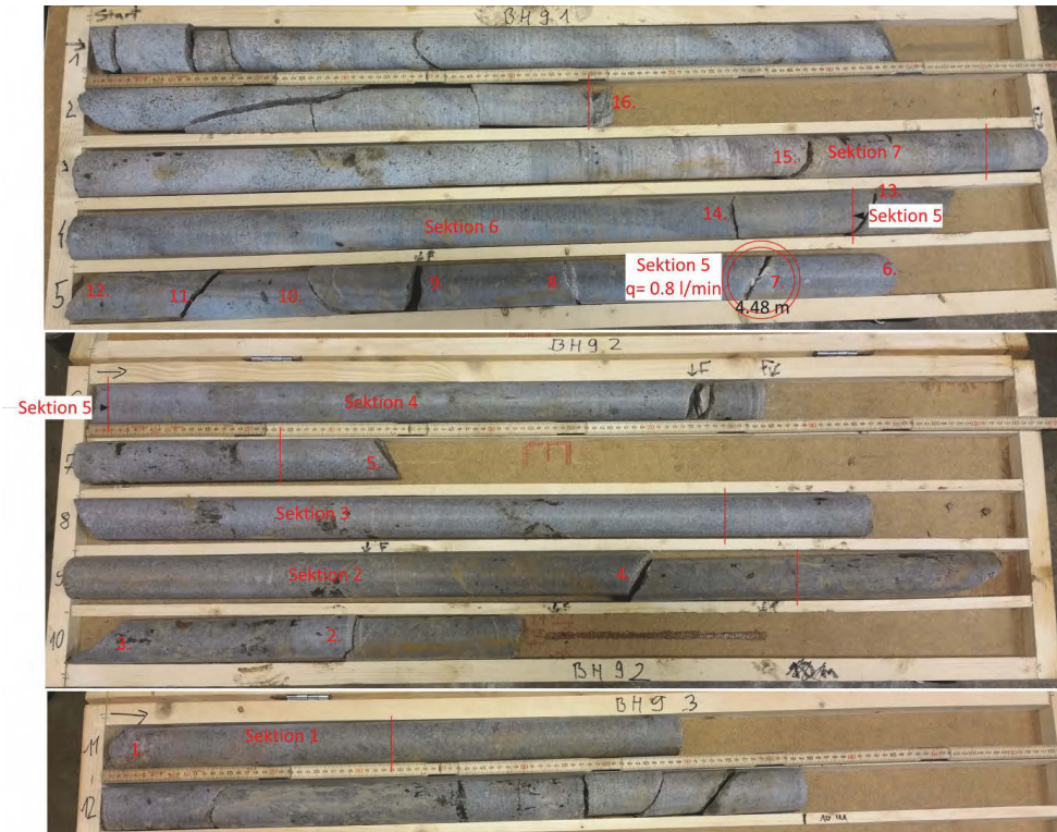
Figur 3: Borrkärna från BH9 med markerade sprickor och 1m-sektioner. Sektion 1 är längst in i borrhålet.
