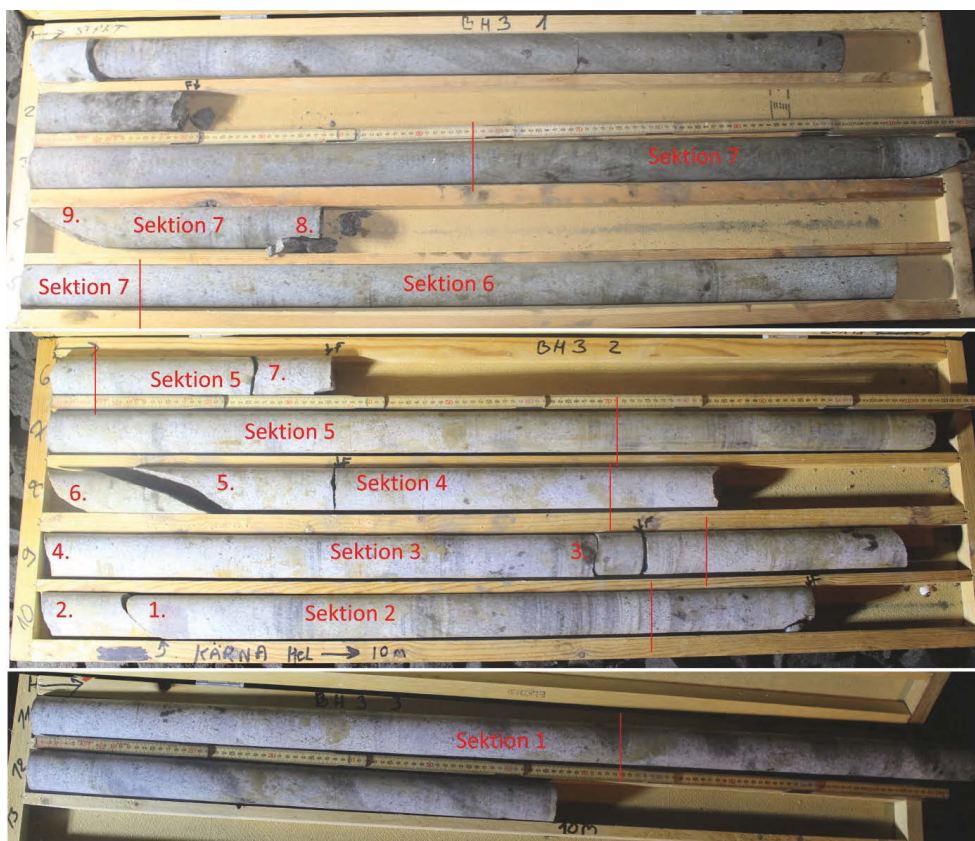
Figur 3: Borrkärna från BH3 med markerade 1m-sektioner och sprickor. Sektion 1 är längst in i borrhålet.
