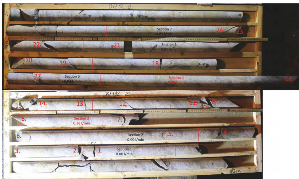
Figur 3: Borrkärna från BH12 med markerade 1m-sektioner. Sektion 1 är längst in i borrhålet.
