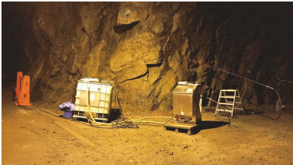
Figur 1: Plats under transmissivitetmätningar av borrhål BH58. Sprickor 5 och 8 är placerade på vänsterväggen nära de orange konerna. Position av sprickorna visas också i Figur 2.
