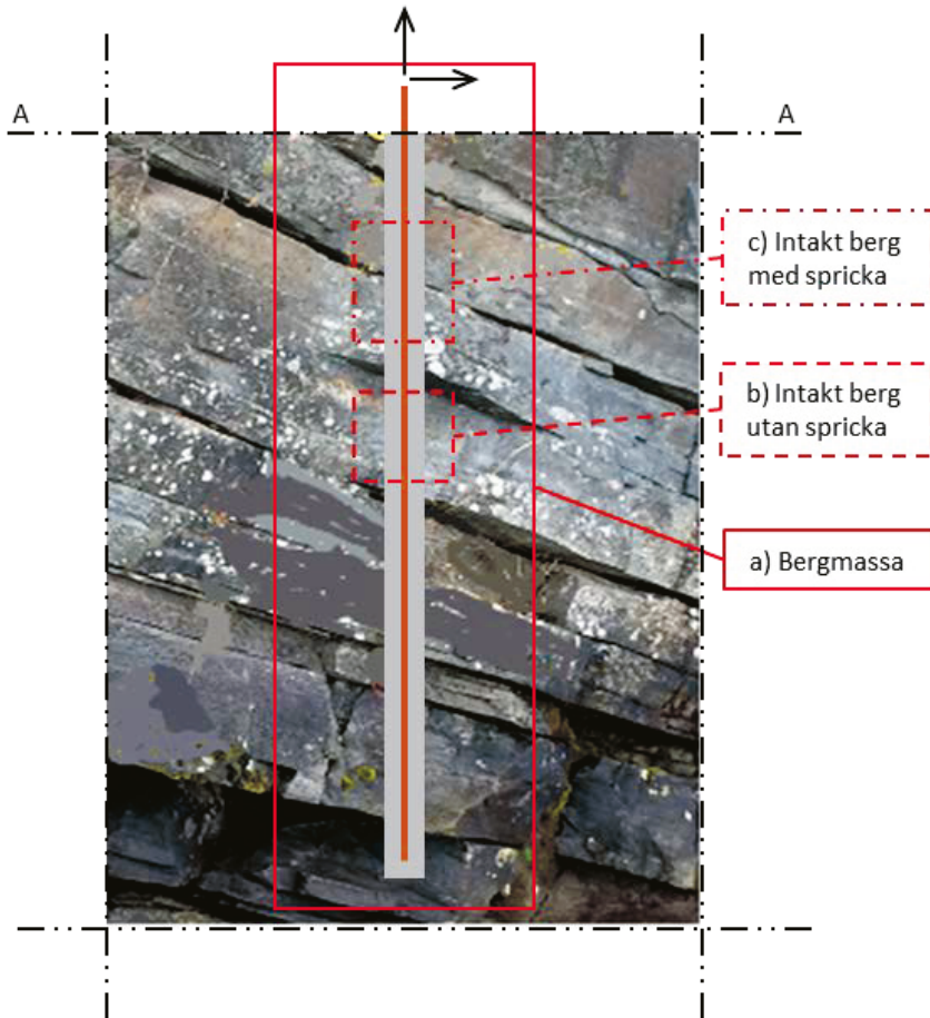
Figur 3-26 Förankrad bult/stång i berg. Anchored bolt in a rock.
