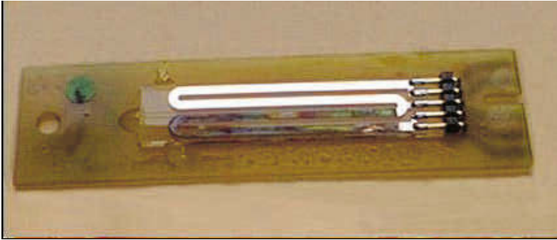
Figur 7-9 Resistanssensor (Rohrback), den övre blanka metallslingan är lackerad och utgör referens. The upper white loop is protected and serves as a reference.
