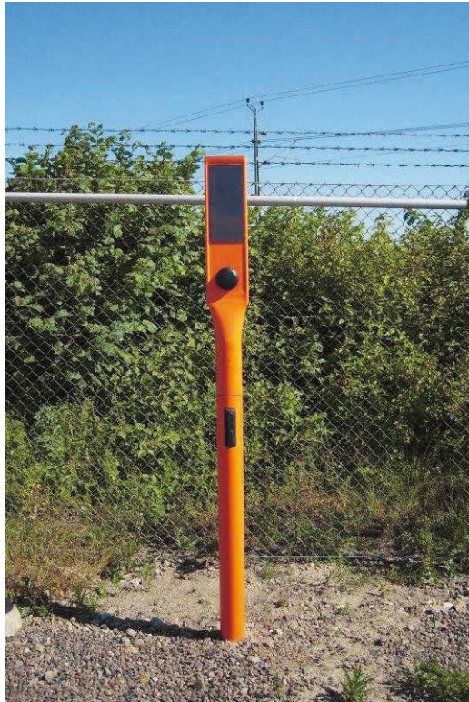
Figur 7-8 Korrosionssond för indikering av frätgropsdjup hos naturgasledningar. Från (Nyberg). Corrosion probe for indicating pitting in natural gas pipelines. From (Nyberg).
