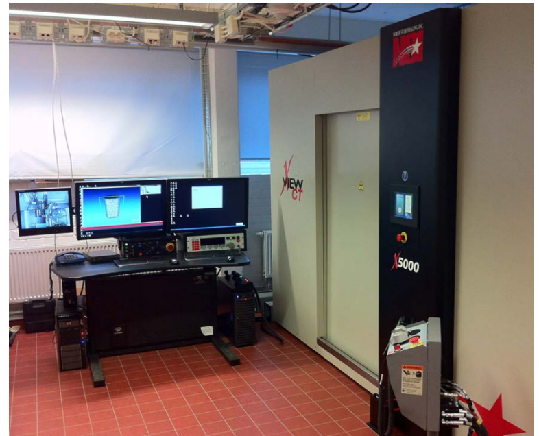
NSI X5000 systemet vid KTH Byggetenskap
