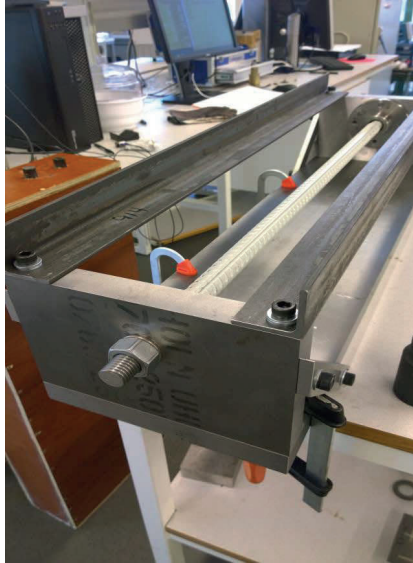
Figur 14 Version 3 av rigg. Till skillnad mot tidigare riggar drar man här i bergbulten genom att skriva in muttern på änden.
