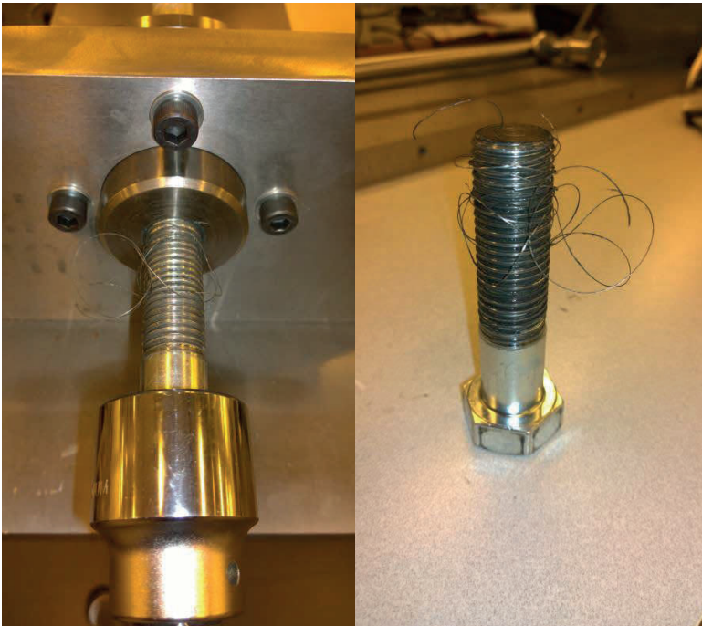
Figur 12 Bult som havererat under belastning. Den höga belastningen gör att gängorna inte orkar hålla emot längre. Resultatet blev att momentnyckeln upplevde en mycket högre kraft än vad som var verkligt, den upplevda kraften var i stället friktion på grund av trasig gänga.
