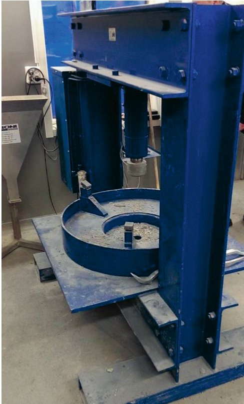
Figur 5 Provutrustning enligt ASTM C1550-12a
