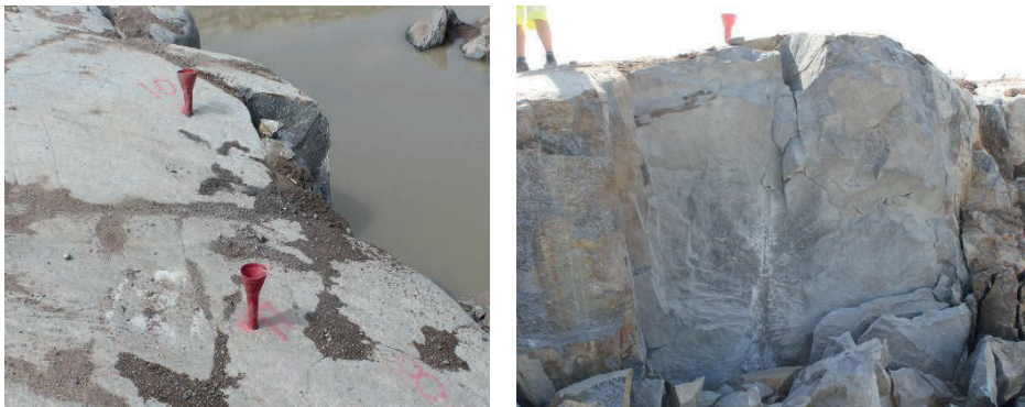
Figur 19. Resultat från sprängning av hål 9 (hålet låg framför hål 10). Blasting result from hole 9
