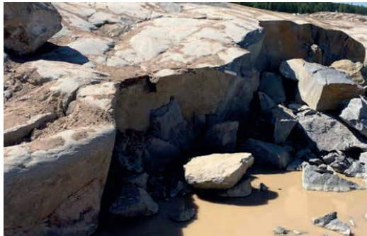
Figur 33. Vittrade och rostfärgade sprickplan där blockutfall skett i samband med sprängning med fritt utslag. Blocks from blasting due to fracture plans
