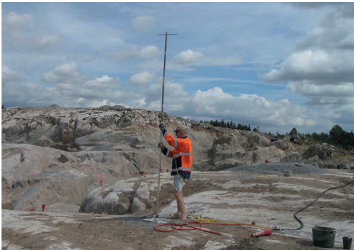
Figur 17. Geofonerna trycks ner i cement i mätthålet. Pushing the geophones down
