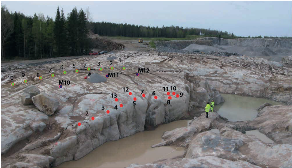
Figur 13. Inmätta hål (hål med fritt utslag är röda, inspända laddningar är gröna och mät hålen mellan dessa). The test holes (holes with breakage are red, confined holes are green and geophones, blue, in between)
