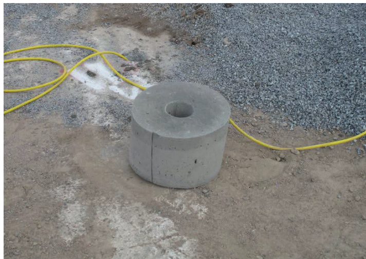
Figur 18. Gjuten fixtur för ytgeofon. Fixture for the surface geophone
