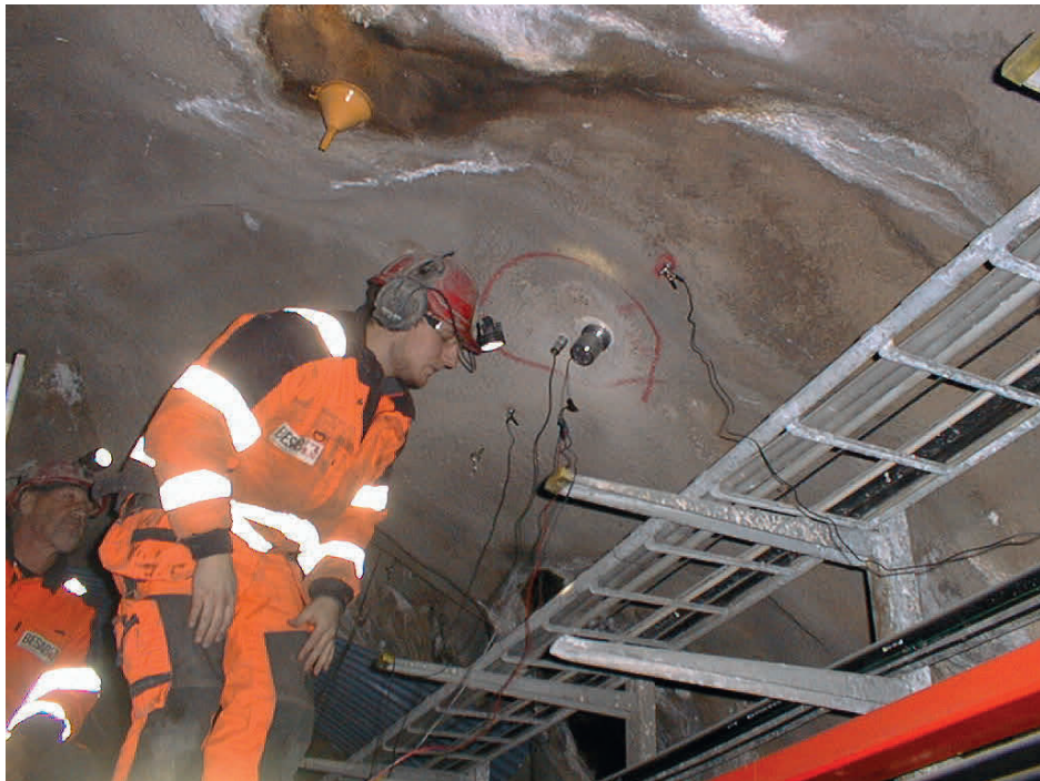
Figur 43. Sensormontage i Gårdatunneln. Innanför den röda cirkeln (skottpunkten) är sprutbetongen planslipad. Där sitter en geofon och den något större vibratorn monterade på fastlimmade aluminiumskivor. Geofonsignalen används för att trigga oscilloskopet. Utanför
