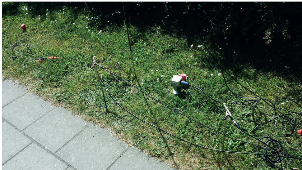
Figur 69. Sensorer från vänster i bilden. Avlägsen geofon, elektrodspett, antennfot, vibrator och källgeofon, elektrodspett. Sensors as they appear from the left: Remote geophone, electrode, antenna-foot, vibrator and the source geophone, electrode.
