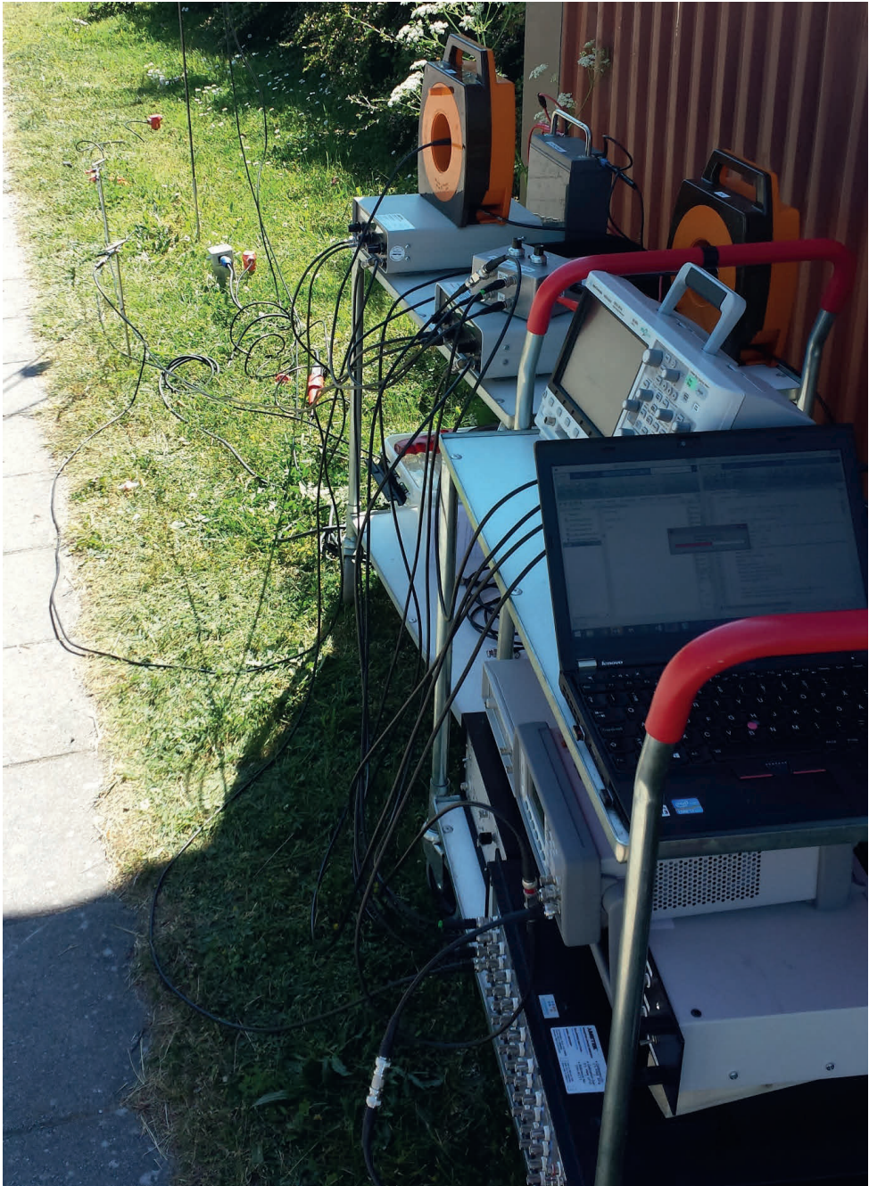
Figur 70. Den omfattande apparaturen som erfordras för detta synbart enkla försök. Nederst till höger den 32 kanaliga lock-in förstärkaren. The paraphernalia needed to perform this seemingly simple test. Down right the 32 channel lock-in amplifier is visible.
