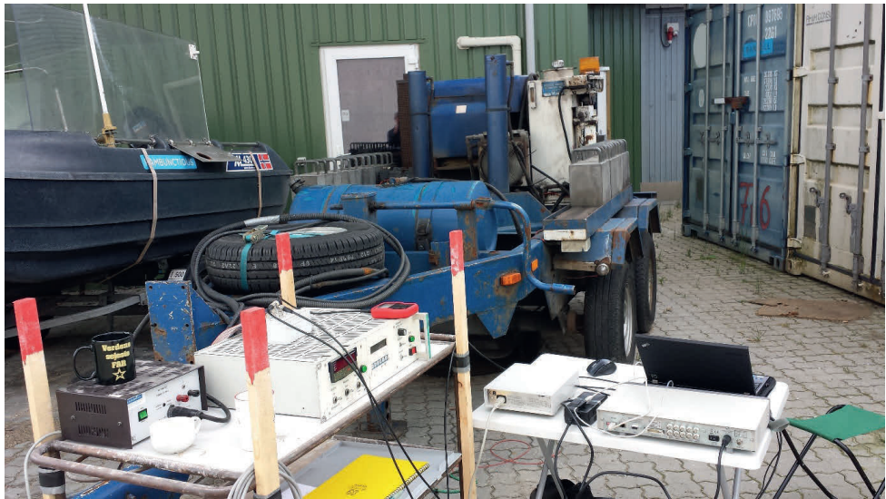
Figur 11. Uppkoppling för test av vibrator. Vibratorn är det blå ekipaget. På vagnen närmast kameran finns vibratorns styrelektronik. På vagnen till höger finns våra instrument, kopplade till vibratorns styrelektronik via IVI-adaptern. Set-up for testing communication with the vibrator. The vibrator is the blue device. On the cart closest to the camera is the vibrator's control electronics connected to the vibrator via the IVI-adpater.
