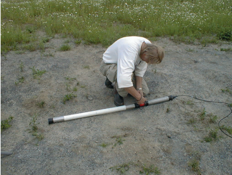
Figur 5. Den seismoelektriska simulatoren klagörs för nedsänkning i borrhål. Den vita delen t.v. innehåller laddningsbara batterier och metalldelarna är elektroderna som alstrar det simulerade seismoelektriska fältet. Delen till höger innehåller den optoelektriska elektroniken och förstärkare. Kabeln är en metallfri optisk tvåledare, varav endast en fiber utnyttjas. Den andra kan utnyttjas om simulatoren kompletteras med en funktion för mätning av elektriska fält nere i borrhål. The seismoelectric simulator is prepared for lowering in a borehole. The white part to the left contains batteries and the metal parts are the electrodes that generate the simulated seismoelectrical field. The part to the right contains the optoelectronics and an amplifier. The cable is a non-metallic two fiber optical link. Only one fiber is used presently. The other fiber can be used if the simulator is extended to measuring electrical fields in a borehole.
