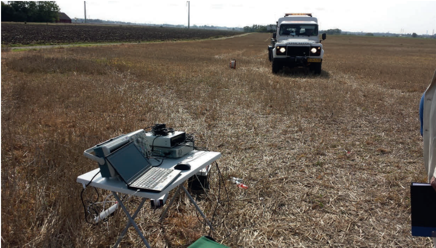
Figur 20. Mätupställning. Mellan vibratorn bakom Land-Rovern och instrumenten är en geofon och en elektrisk dipol utplacerade. Test set-up. Between the vibrator behind the Land-Rover and the instruments a geophone and an electric dipole are located.
