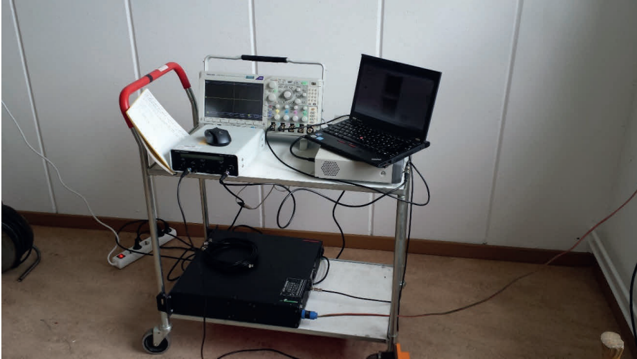
Figur 18. Den utrustning som användes vid funktionskontroll av mjukvara utvecklad för försök med enkanalig lock-in förstärkare. Equipment used when the developed software for experiments with a single-channel lock-in amplifier is used was checked.
