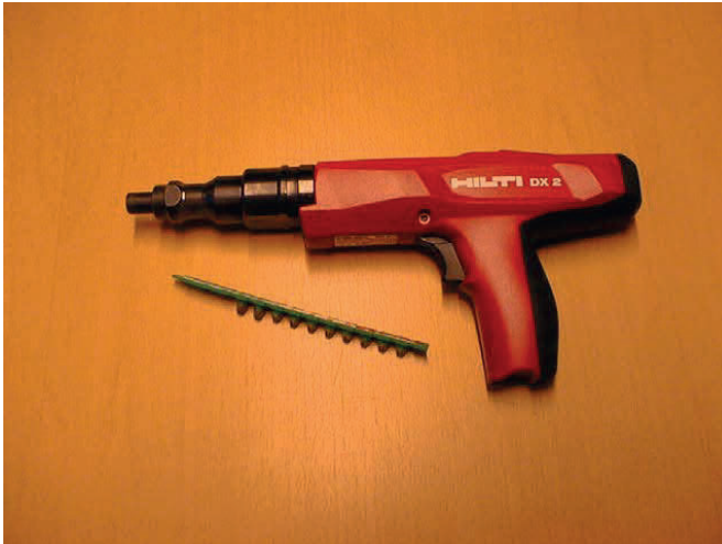
Figur 44. Bultpistol med krutladdningar på remsa. Pistolen avfyras direkt mot berget utan något spik i loppet. Pistongen slår alltså direkt mot berget. Detta ger en mycket kraftig och repeterbar signal. Bolt-gun with shells. The gun is fired directly against the rock without any nail in the barrel. The piston slams directly into the rock. This provides a very strong and repeatable signal.
