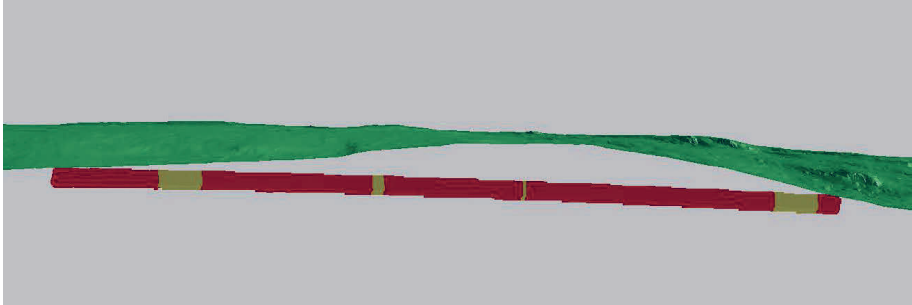
Figur 9. Blockmodell över norra tunnelröret visande Q-bas från driftskarteringen. Röd färg representerar Q-bas >10, gul färg representerar Q-bas 4-10.
