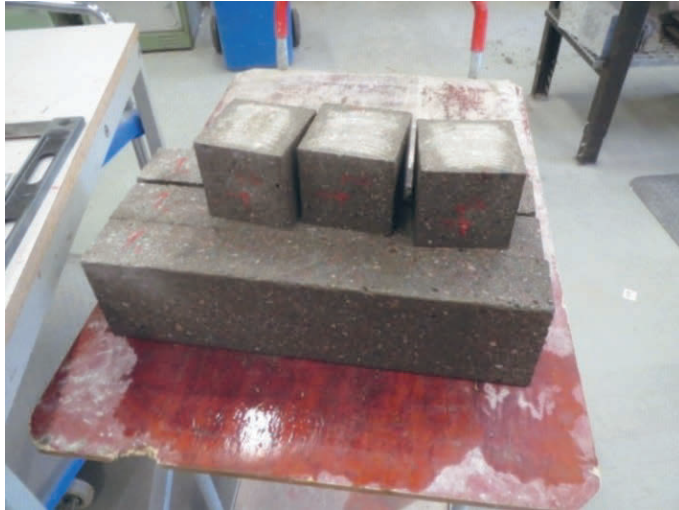
Figure 3.1. Test specimens from spray boxes, for compressive and flexural crack strength. Provkroppar sågade ur sprutlådor, för tryck- och böjdraghållfasthet.
