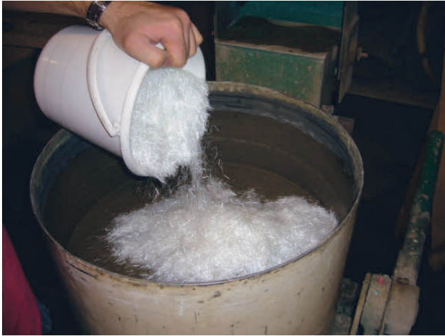
Figure 2.5. Micro fibres – here 6 mm long glass fibres. Mikrofibrer – här 6 mm långa glasfibrer.
