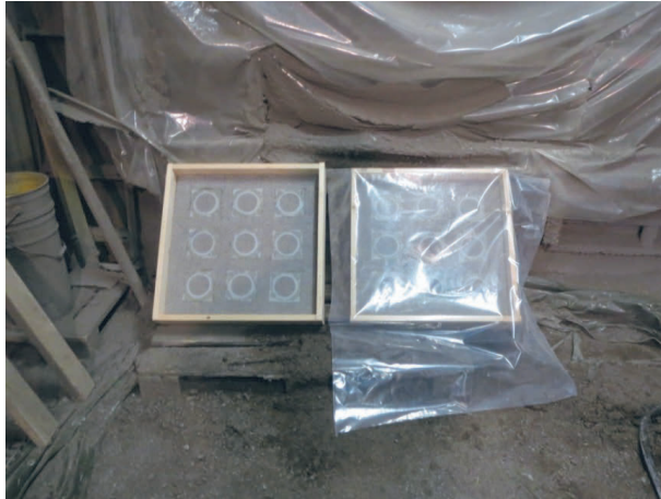
Figure 3.8. Special test boxes for bond strength tests. Särskilt tillverkad låda för vidhäftningsprovning.
