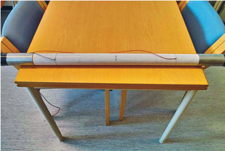
Figur 24. Simulatorns batteri och elektroddel försedd med två tillfälligt monterade mätprobar med ett inbördes avstånd om 0.500 m. The battery and electrode part of the simulator equipped with temporary probes for measuring the actual electric field created in water.
