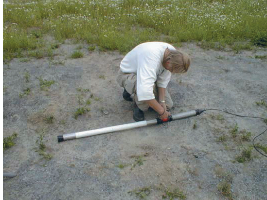
Figur 25. Simulatorens förberedelse för nedsänkning i borrhålet The simulator is prepared for descent into the borehole.
