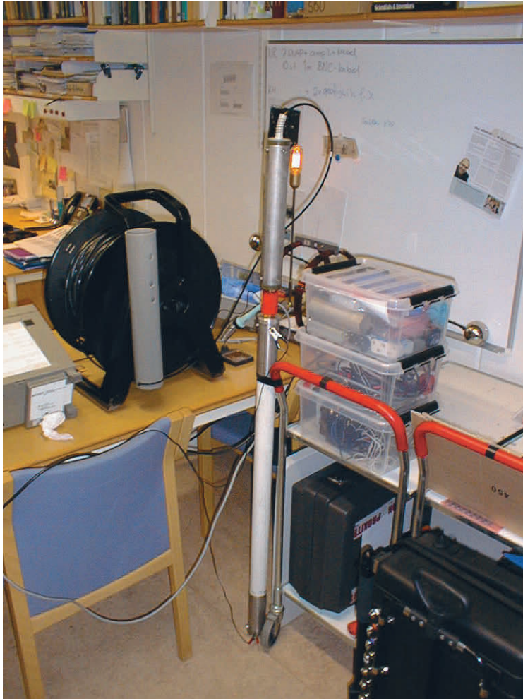
Figur 21. Seismoelektrisk simulator: Kabeltrumma med elektrooptisk omvandlare, elektronikdel med optoelektrisk omvandlare och förstärkare (överst) samt batteri och elektroddel (vitt rör nederst) Seismoelectric simulator. The cable reel carries the optofiber and contains the electro-optic converter. In the downhole probe there is an opto-electric converter an amplifier and batteries (in the white tube).
