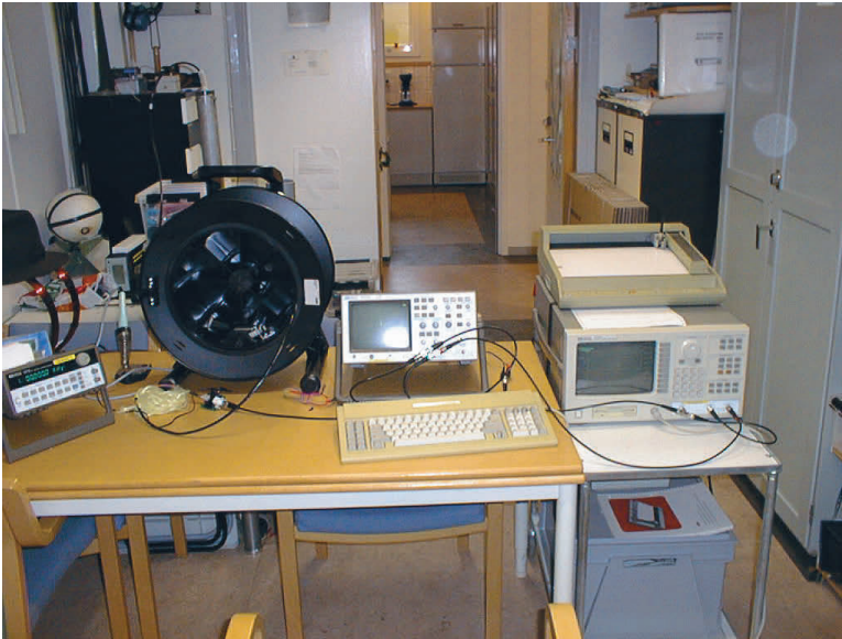
Figur 22. Den svarta kabeltrumman innehåller den optiska fiberkabeln och sändarelektroniken. Instrumentet till höger är signalanalysatorn som styr försöket. Ett oscilloskop används för att kontrollera att vågformerna ser korrekta ut under analysatorns frekvenssvep. The black cable reel contains the optofiber and transmission electronics. The instrument to the right is a Dynamic Signal Analyzer which controls the experiment. An oscilloscope is used to inspect the signal waveforms throughout the frequency range inspected.
