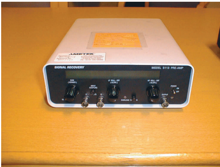
Figur 11. Förförstärkare av typen Signal Recovery 5113 med möjlighet att koppla ingångarna A och B (till vänster på panelen) så att differentiell mätning erhålles (A-B). Preamplifier Signal Recovery 5113 with the option to use inputs A and B (to the left on the front panel) as a differential input.
