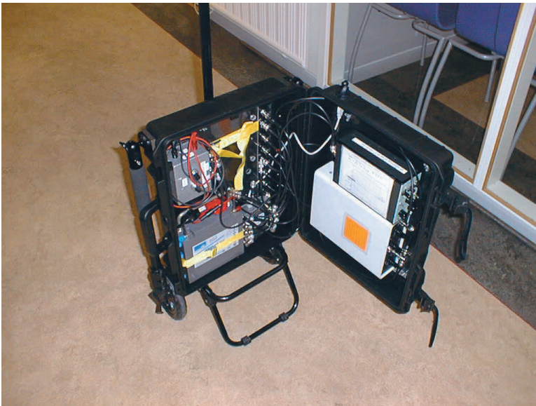
Figur 8. Mångkanalsystemet med locket uppfällt. Data samlas in i en extern dator av samma typ som visas i föregående figur.
