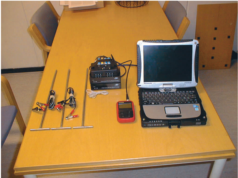
Figur 7. I bilden visas de tre elektroderna med anslutningskablar, RIAA-förstärkarna med dämpsatser, oscilloskopet som används för att ställa in dämpningen samt den dator som lagrar de digitaliserade värdena. Snöret används för att enkelt placera ut elektroderna med en meters mellanrum.
