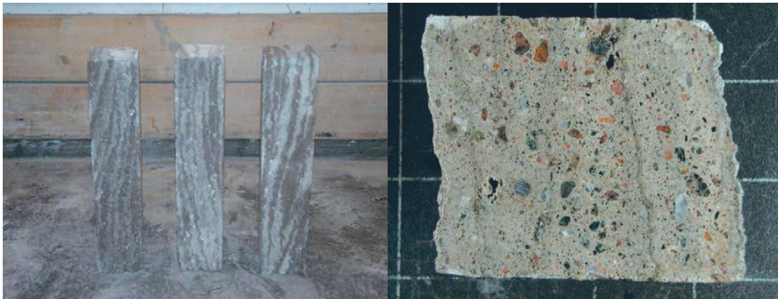
Figur 1. Bilder som visar sprutbetongs (våtsprutad) inhomogenitet. Bilden till vänster visar delvis uttorkade prismor där de grå partierna visar mera porös och fuktig betong. Till höger på en polerad yta kan man se ojämna fördelning av ballast. De tunna lite mörkare lagren visar en övergång mellan två olika sprutsikt. Provet är från Shelltunneln.
